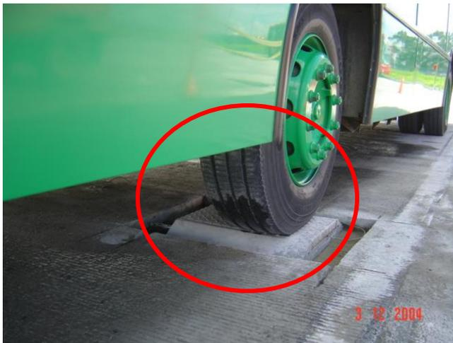
**Figura 8. Se observa ubicación de la llanta sobre la báscula.**
