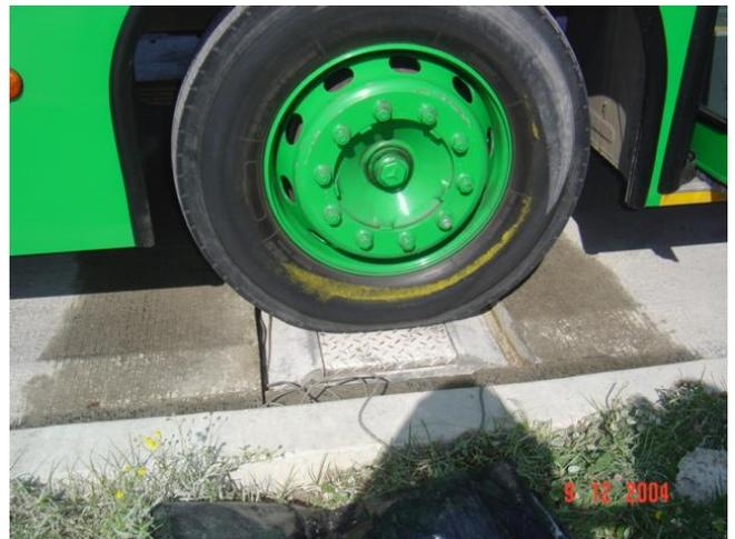
**Figura 9. Ubicación centrada de la llanta sobre la báscula vista lateral.**
