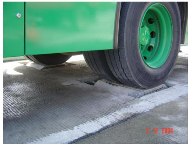
Figura 5. Eje trasero colocado sobre la báscula durante el proceso de calibración.
