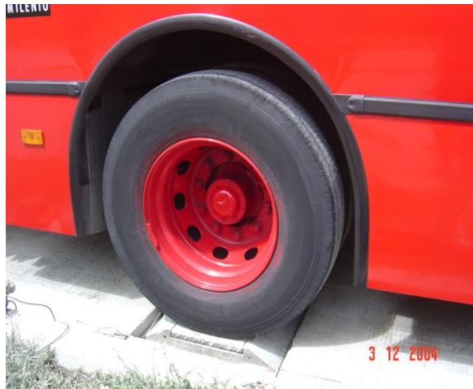
**Figura 7. Eje trasero colocado sobre la báscula durante el proceso de calibración.**
