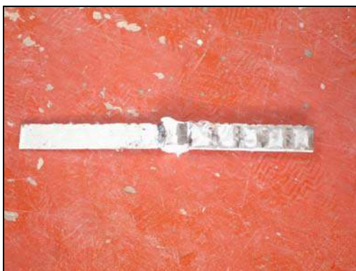
Figura 8.9-24 Ensayo de corte con pega elástica en acero de rejillas
