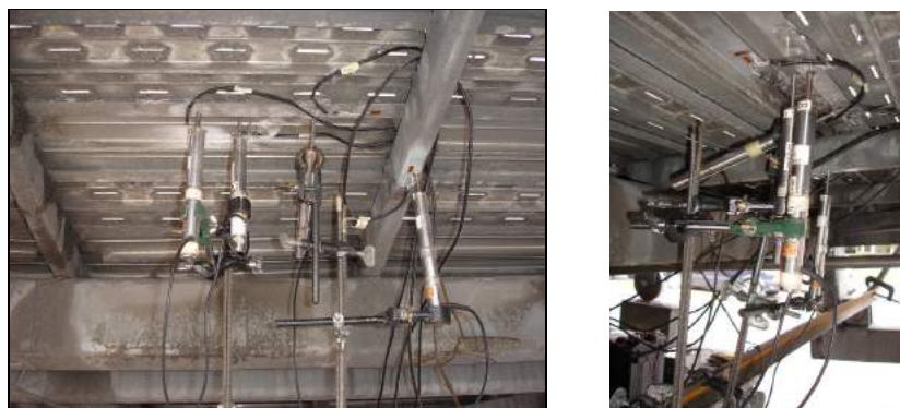
Figura 4-24 Localización de los LVDT
