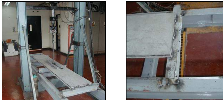
Figura 8.3-17 Montaje para ensayo de fatiga del concreto pretensado
