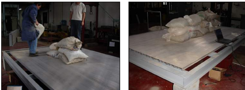
Figura 6-18 Fotografías ensayo de carga distribuida
