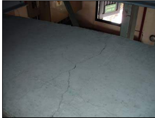
Figura 8.3-16 Mecanismo de falla ensayo de punzonamiento
