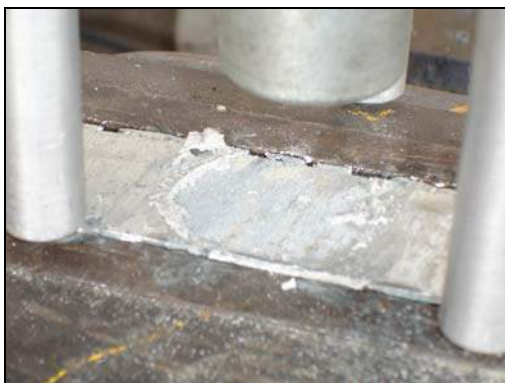
Figura 8.9-11 Ensayo de tensión del imprimante sobre acero de rejillas
