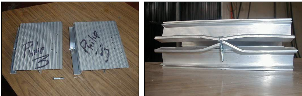
Figura 6-12 Modos de falla para el ensayo No 1
