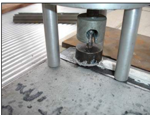
Figura 8.9-14 Ensayo de tensión del imprimante en metal del módulo de concreto pretensado
