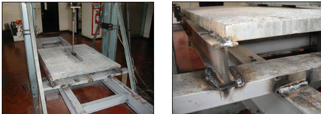
Figura 8.6-19 Montaje para ensayo de fatiga de rejillas metálicas
