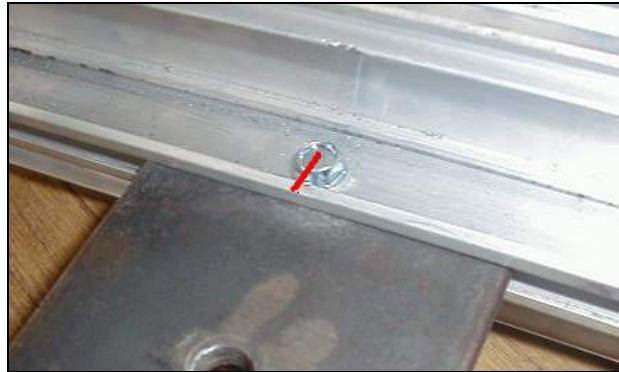
Figura 6-10 Localización de perforación para el ensayo No 1
