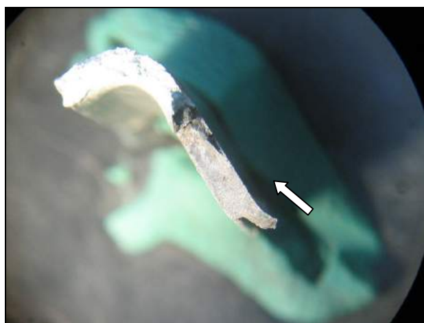
Figura 5-50 Fractografía (x5) de la zona donde progresó la grieta del perfil fallado.
