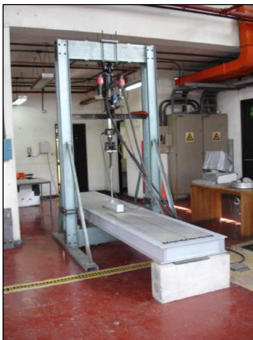
Figura 6-21 Esquema de Montaje para ensayo de fatiga
