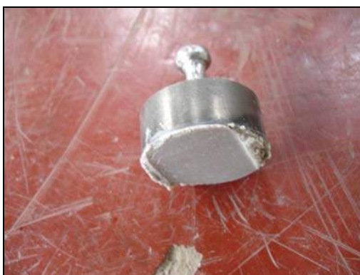
Figura 8.9-6 Dolly retirado después de efectuar el ensayo de tensión sobre el sustrato de aluminio, no se presentó falla del sustrato
