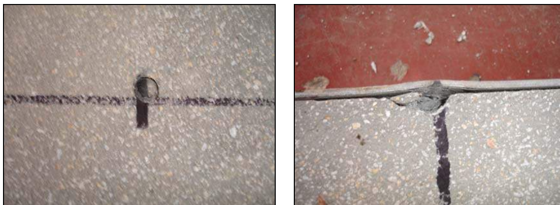
Figura 8.4-17 Mecanismo de falla ensayo de punzonamiento
