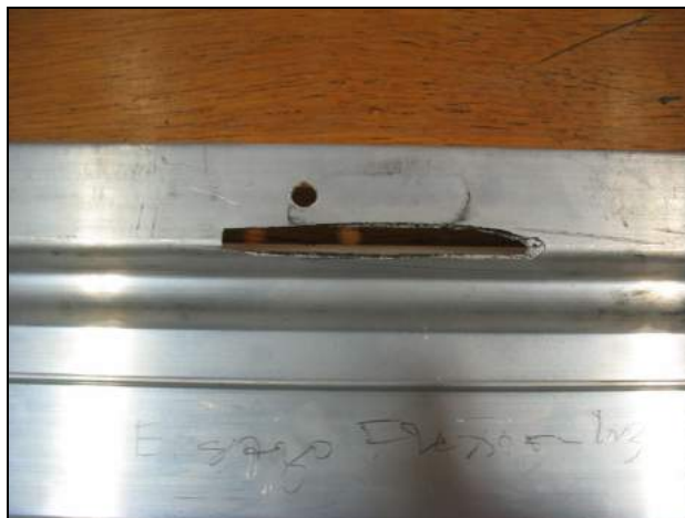
Figura 5-49 - Detalle de la falla presentada en prueba realizada sobre el perfil
