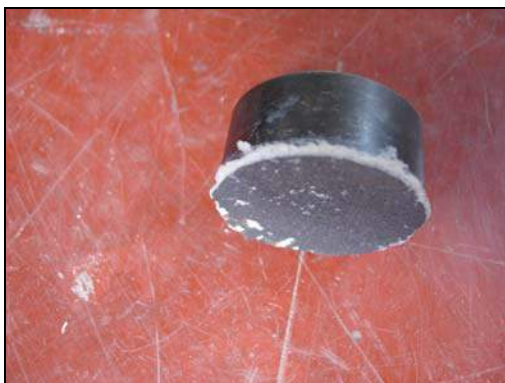
Figura 8.9-15 Falla debida al desprendimiento de la pintura
