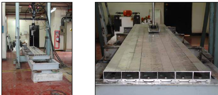
Figura 8.5-11 Montaje para ensayo de fatiga de Aluminio
