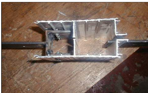
Figura 6-9 Detalle de montaje del perfil para el ensayo No 1
