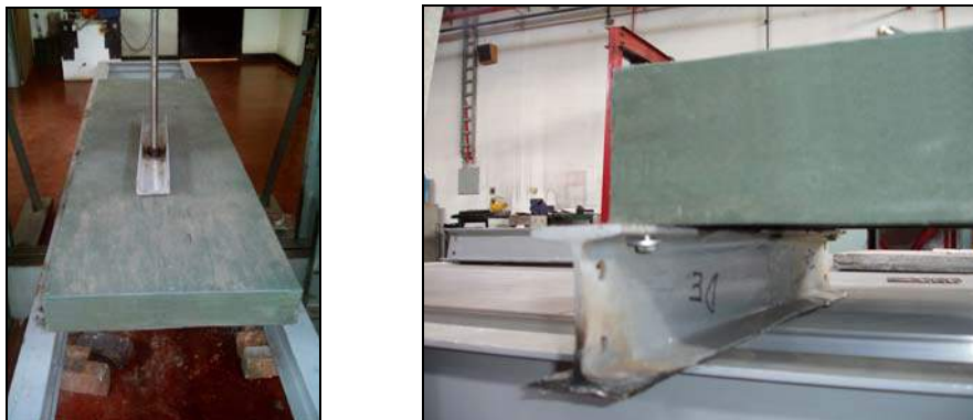
Figura 8.2-17 Montaje para ensayo de fatiga materiales sintéticos
