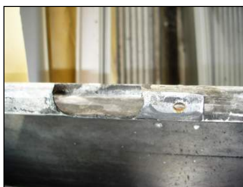
Figura 5-55 Desgaste en apoyos en láminas reinstaladas.
