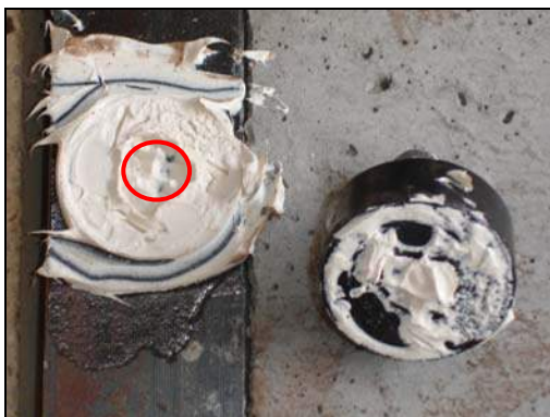
Figura 8.9-20 Ensayo de tensión en pega elástica sobre acero del módulo de concreto pretensado
