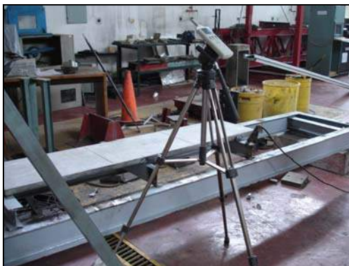
Figura 8.4-20 Medición de ruido condición No 1
