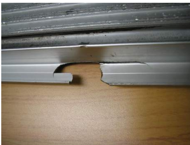
Figura 5-45 Detalle de una fractura por propagación de grietas durante el proceso de fatiga
