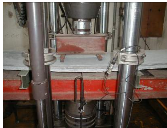
Figura 8.3-11 Esquema de ensayo a flexión de láminas
