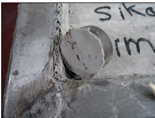
Figura 8.9-10 Ensayo de tensión del imprimante sobre el acero del módulo de GRC
