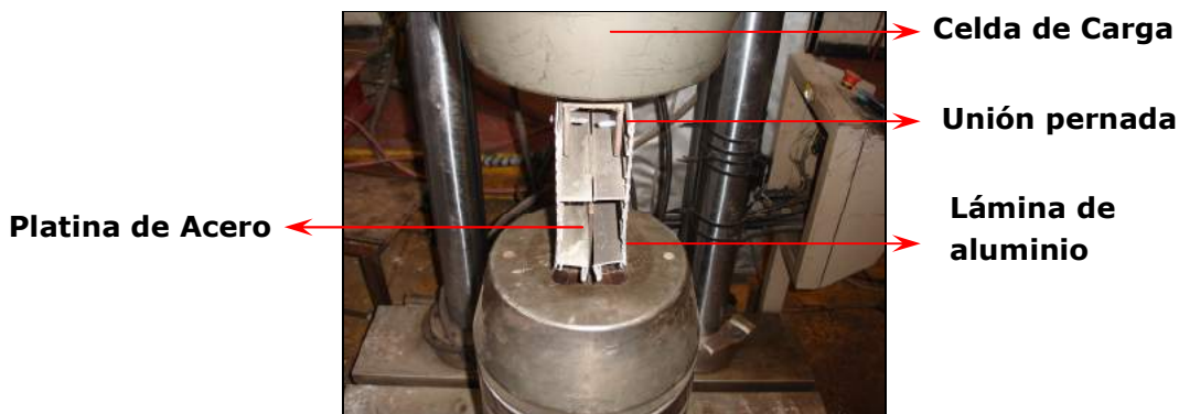
Figura 6-7 Esquema de ensayo de desgarramiento
