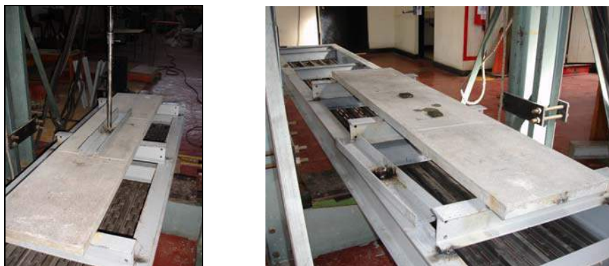
Figura 8.4-18 Montaje para ensayo de fatiga de GRC
