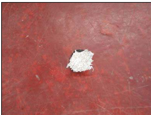
Figura 8.9-16 Ensayo de tensión en pega elástica sobre madera sintética
