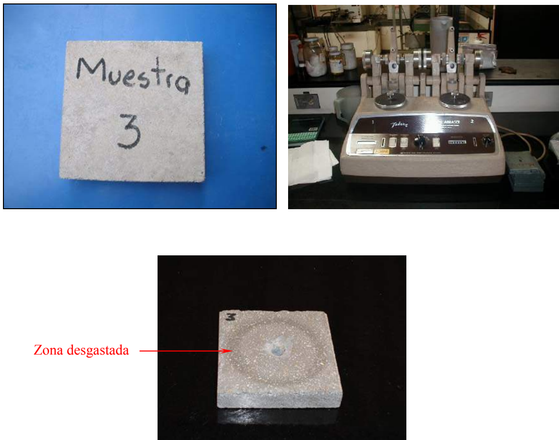
Figura 8.3-9 Probeta y montaje de ensayo de desgaste para el concreto pretensado
