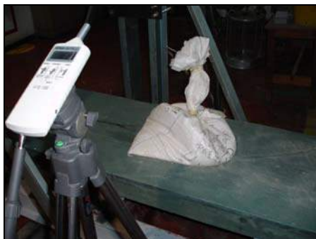
Figura 8.2-21 Medición de ruido condición No 3
