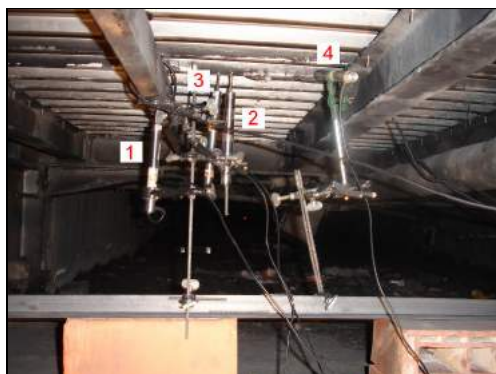
Figura 4-12 Localización de los LVDT
