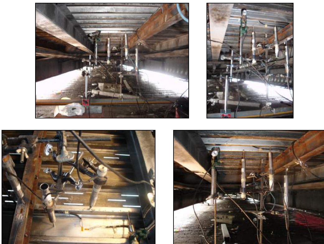
Figura 4-18 Localización de los LVDT
