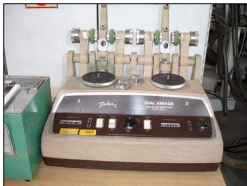
Figura 8.2-12 Probeta y montaje de ensayo de desgaste para Material sintético
