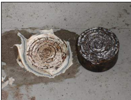
Figura 8.9-21 Ensayo de tensión en pega elástica en concreto pretensado
