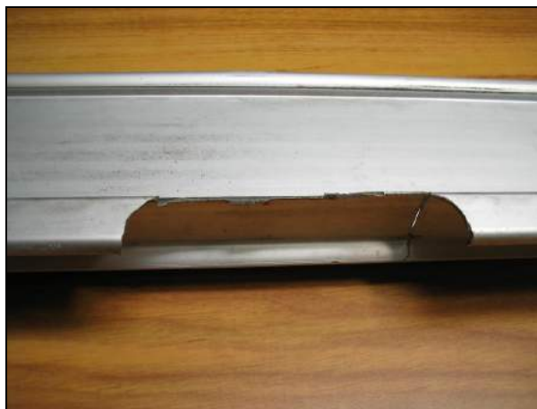
Figura 5-46 Fractura total de la región de sujeción en la aleta de un perfil de Lehner bajo condiciones de campo
