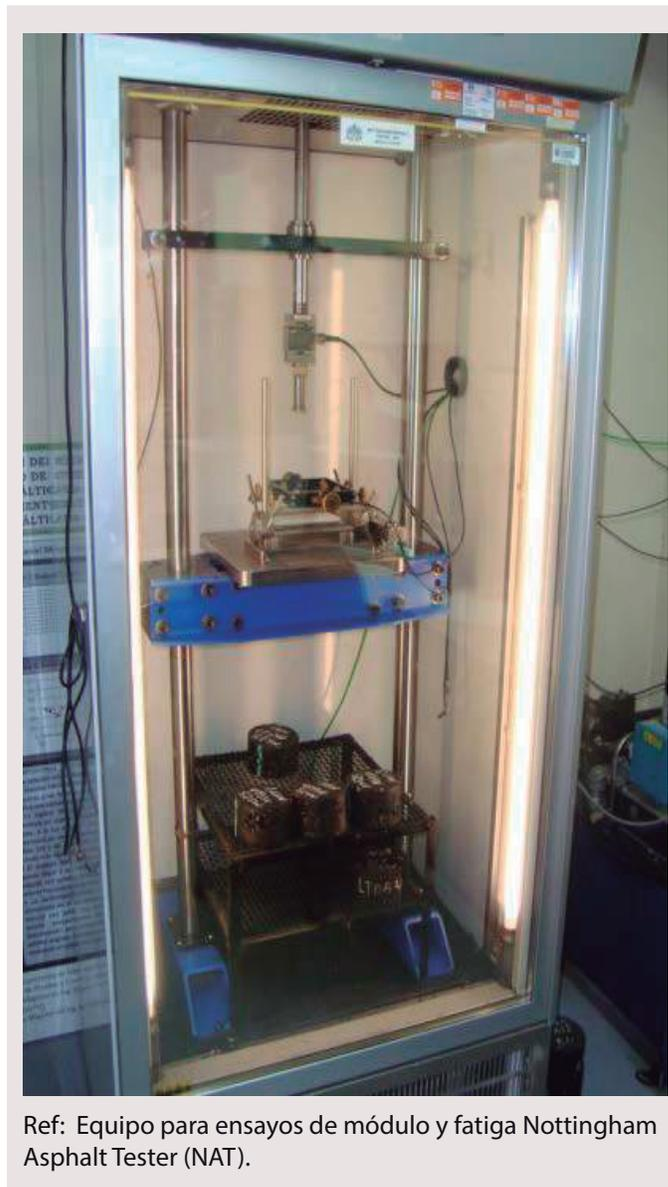
Ref: Equipo para ensayos de módulo y fatiga Nottingham Asphalt Tester (NAT).
