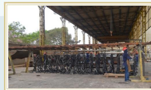
Figura 19. Piezas metálicas en negro alistada por el operario en las gancheras para la entrada del material a los ácidos.
