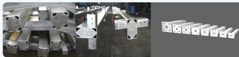
Figura 17. Indica los destijeres y perforaciones que debe llevar las secciones cuadradas o perfiles tubulares
