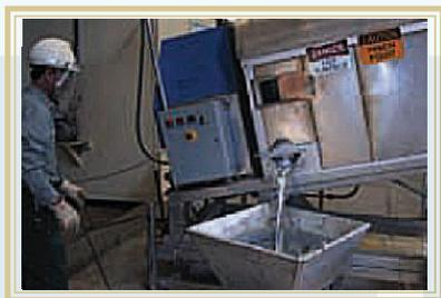
Figura 47. Proceso de reutilización de las cenizas de zinc.
