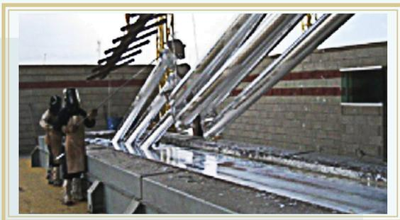
Figura 5. Tubería galvanizada en cuba de Galvanizado por inmersión en caliente en Barranquilla.
