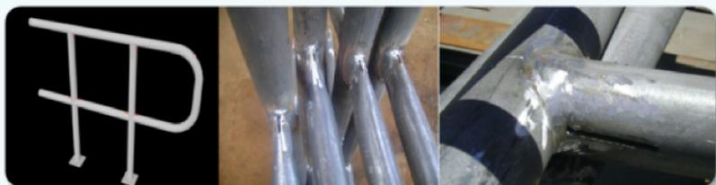
Figura 15. Imágenes de destijeres en estructura tubular, los puntos rojos de la primera figura indican los puntos en donde debe llevar un destijere Fuente: B-Bosh - Chile
