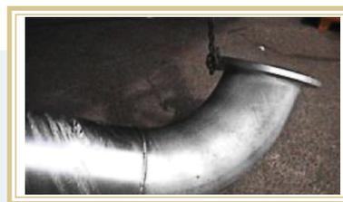
Figura 32. Acabado de tubería galvanizada con apariencia brillante y mate. Fuente: LATIZA. "Guía para la Galvanización en caliente".
