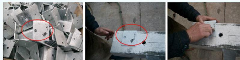
Figura 37. Piezas o elementos con zonas sin recubrimiento de galvanizado, Fuente: B-Bosh - Chile.
