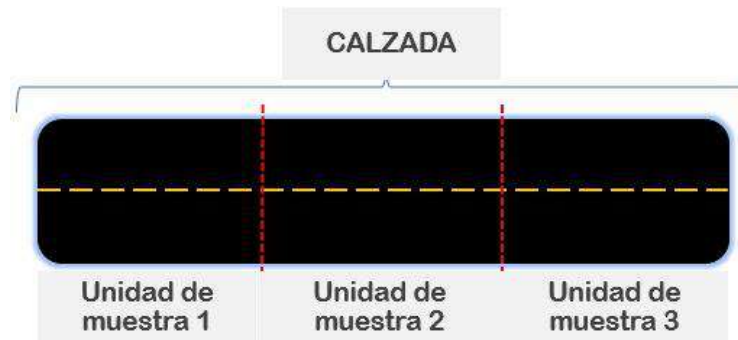
Gráfica 3. Ejemplo esquemático de las unidades de muestra en una calzada
