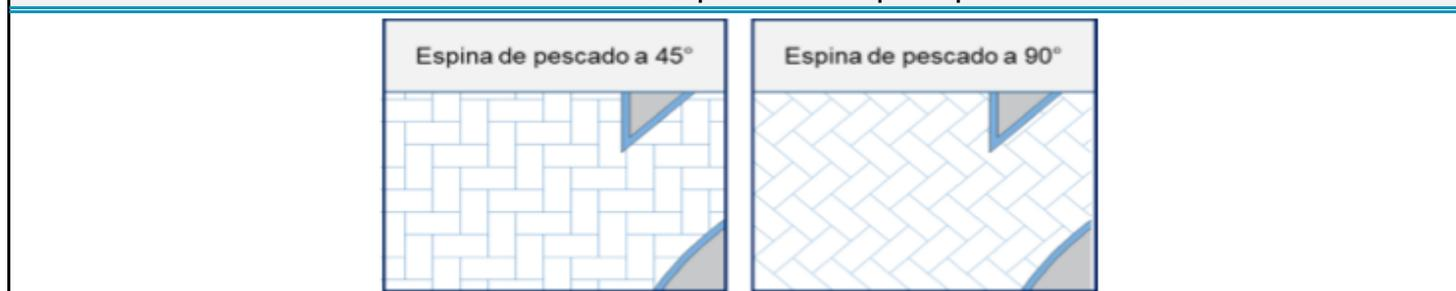
Ilustración 1020.6 Patrón de colocación en Espina de Pescado para superficies de tráfico vehicular
