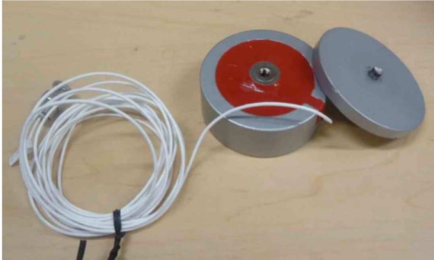
**Figura 4.5.** Sistema de Protección para el Sensor de Celda o Esfuerzo Vertical
