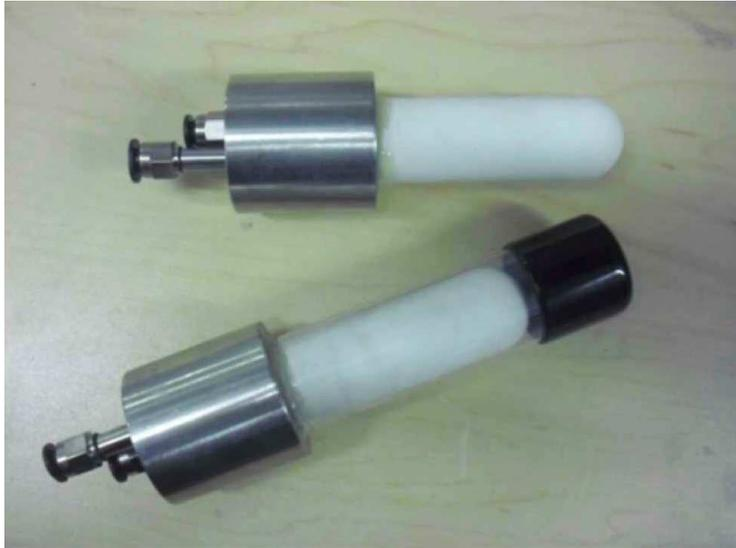
**Figura 4.1.** Dispositivos mecánicos para los Tensiómetros
