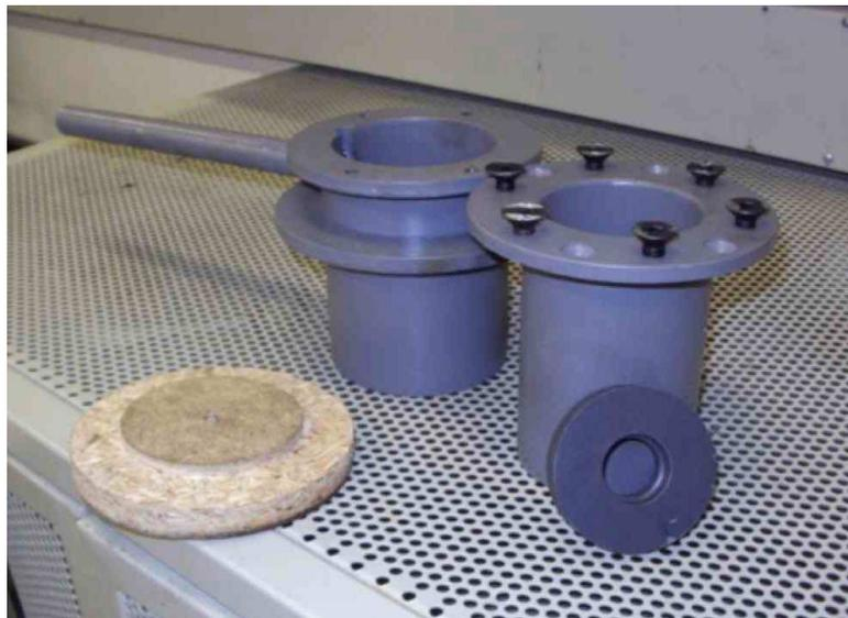
**Figura 4.4.** Sistema de Montaje para los deflectómetros
