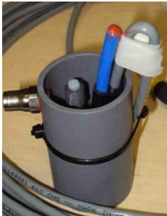
**Figura 4.6.** Dispositivo mecánico funcional para el Sensor de Presión de Poros Dinámica
