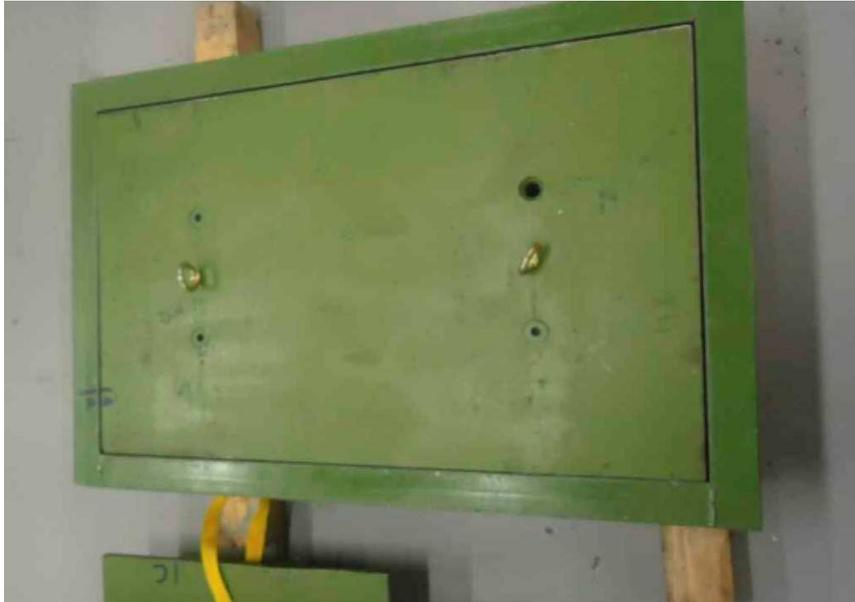
**Figura 4.3.** Caja Metálica para la Placa Instrumentada de Medida de Carga
