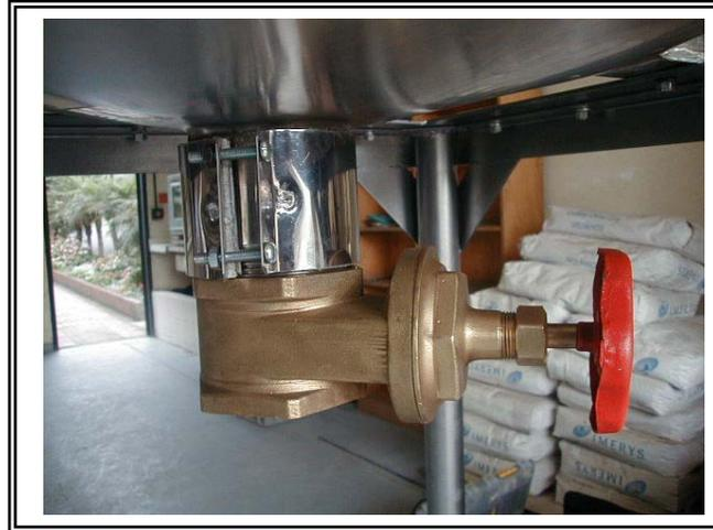
**Figura 8.6. Válvula de salida del reactor**
