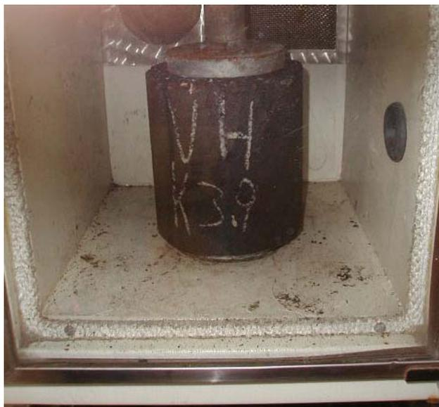
**Figura 6.12. Estabilización térmica de las briquetas para la prueba de Módulo Dinámico**
