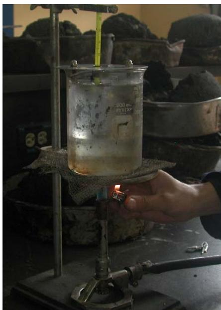
**Figura 5.8. Montaje Prueba Anillo y Bola**
