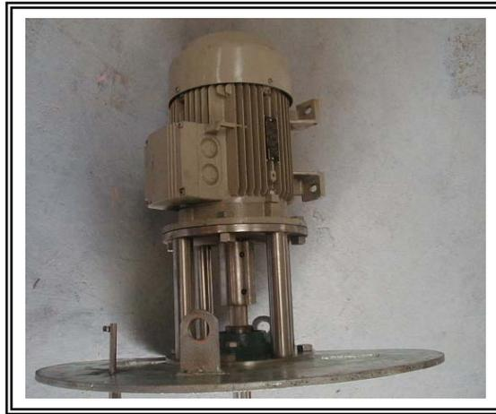
**Figura 8.8. Motor del mezclador**
