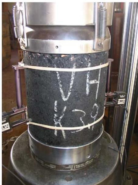
**Figura 6.13. Prueba de Módulo Dinámico en la MTS.**
