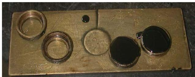
**Figura 5.7. Probetas de la Prueba Anillo y Bola**
