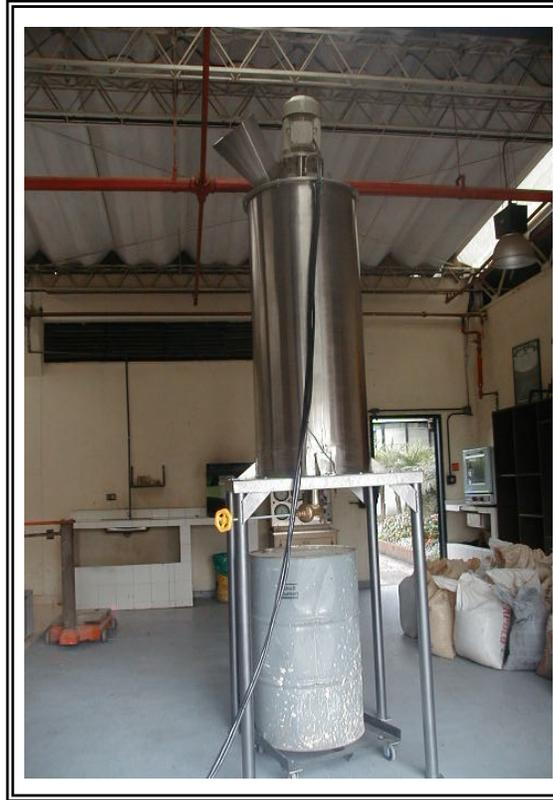
**Figura 8.4. Tanque reactor con motor y tolvas de alimentación**
