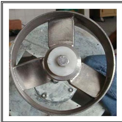
**Figura 8.10. Impeler del mezclador**
