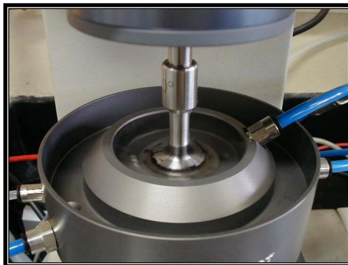
**Figura 5.7. Ensayo de DSR, disco de 25 mm.**
