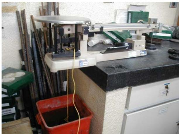
**Figura 6.11. Procedimiento para determinación del peso específico bula.**
