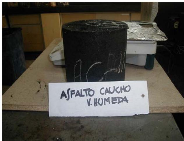
**Figura 6.10. Briqueta conformada luego de compactación giratoria.**
