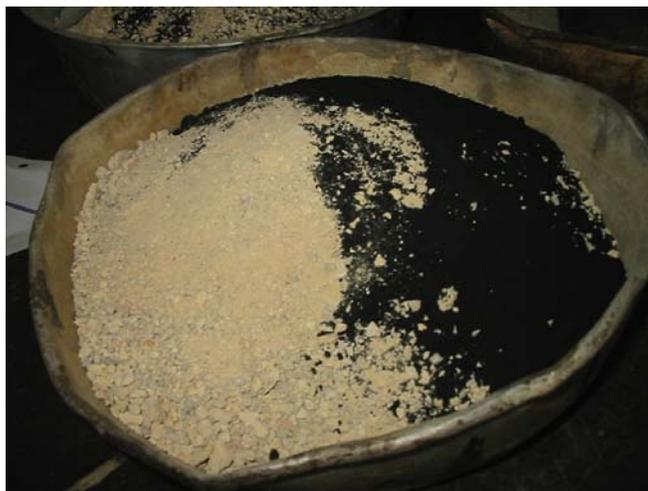
**Figura 6.8. Material retenido tamiz 50 de la arena de Guamo junto a la fracción de GCR correspondiente**
