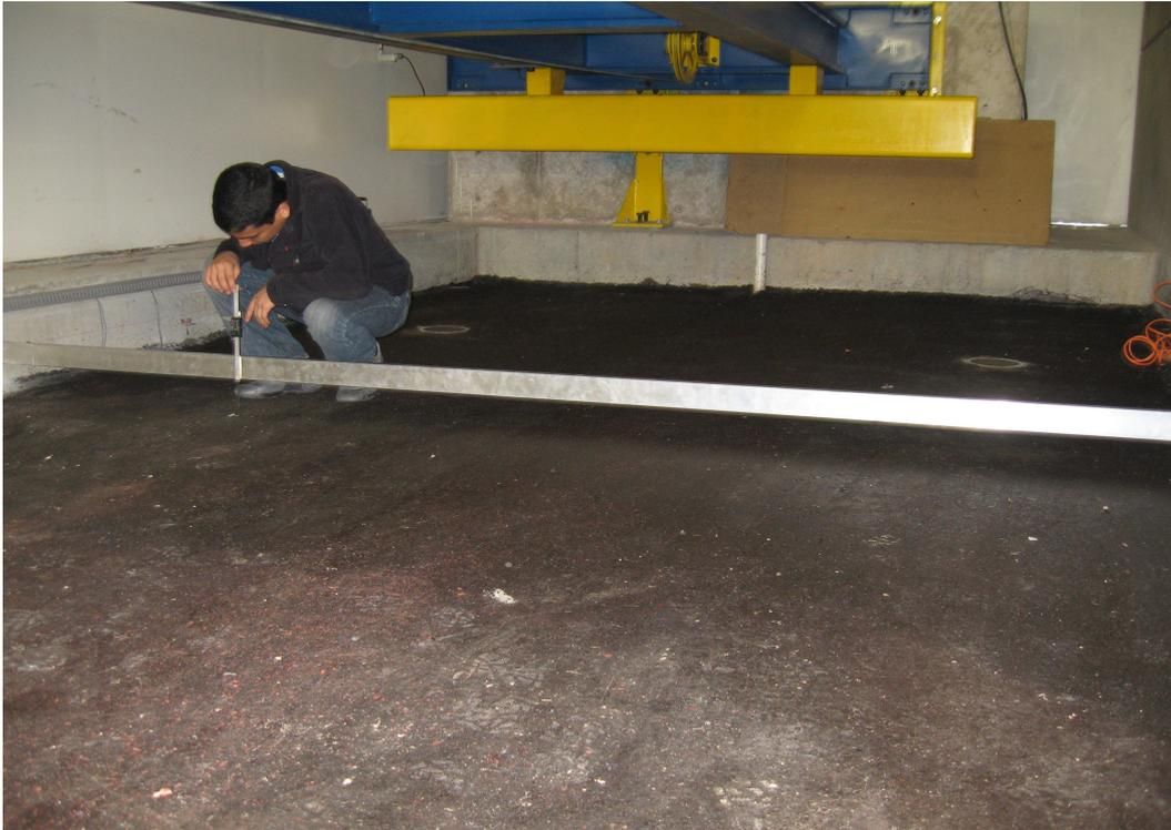
**Fotografía 5. Medición de deformación permanente o ahuellamiento**
