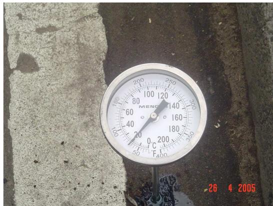
**Figura 53. Toma de Temperatura previo a la medición de deflexiones.**
