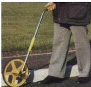
**Figura 48. Odómetro Manual**
