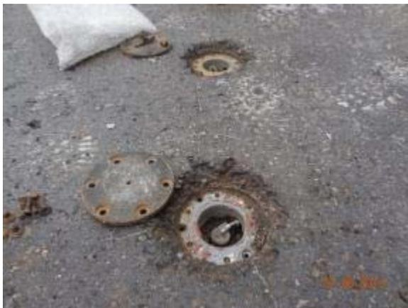
Figura 5.29. Deflectómetro 5 destapado.
