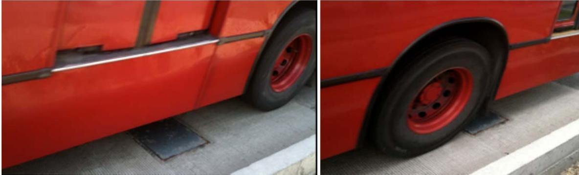
**Figura 7.33.** Detalle del paso de un bus de Transmilenio sobre las balanzas WIM instaladas en la Autopista Norte con Estación Alcalá
