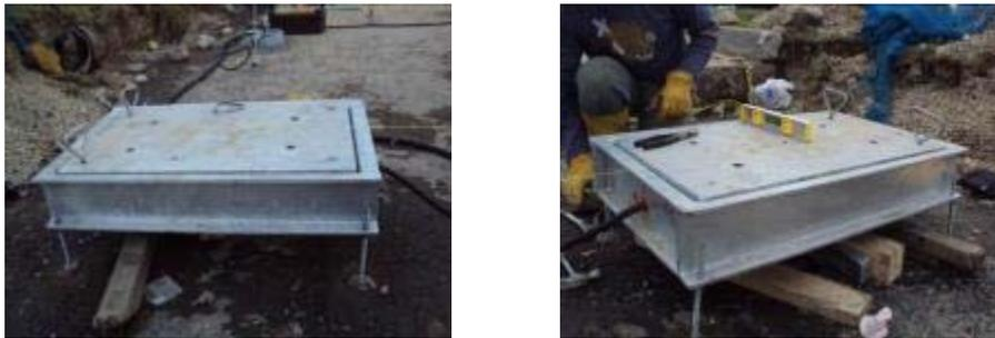
**Figura 3.6.** Placas instrumentadas para medida de carga
