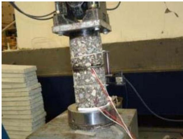
**Figura 5.13.** Ensayo del núcleo instrumentado en la MTS.
