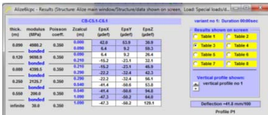
**Figura 10.14.** Datos obtenidos para el punto 1 de aplicación de la carga.
