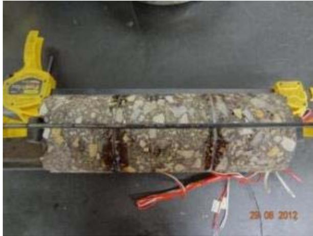
**Figura 5.12.** Pegado de las capas del núcleo instrumentado.
