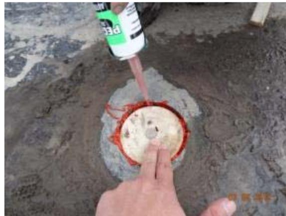
**Figura 5.9.** Pegado de uno de los núcleos falsos de madera con silicona roja.
