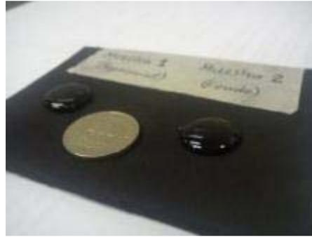
**Figura 8.31.** Muestras de asfalto recuperado, por cada subcapa.
