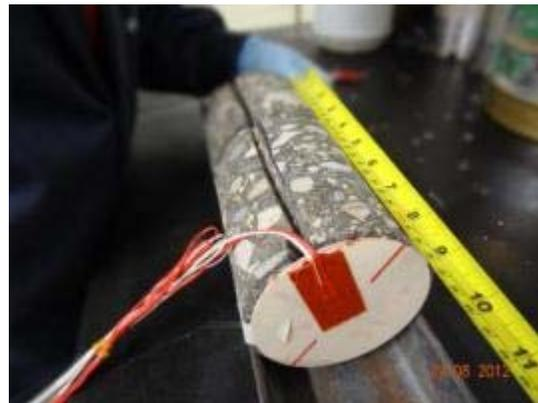
**Figura 5.11.** Pegado de sensores al núcleo.
