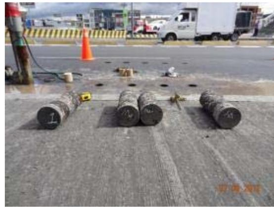
**Figura 5.7.** Vista de los 4 núcleos extraídos, en la huella izquierda de la calzada sur – AC 80 (Calle 80).
