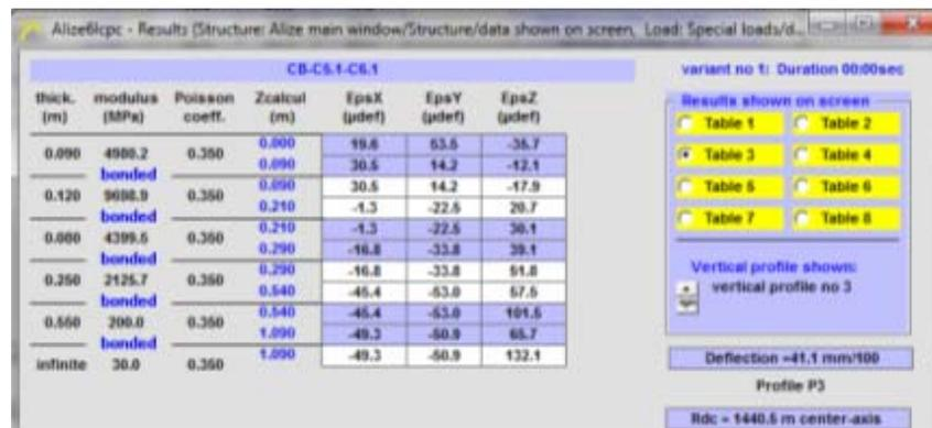
Figura 10.16. Datos obtenidos para el punto 3 de aplicación de la carga.
