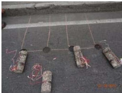
**Figura 5.21.** Planeación de la disposición final en campo de los núcleos instrumentados.
