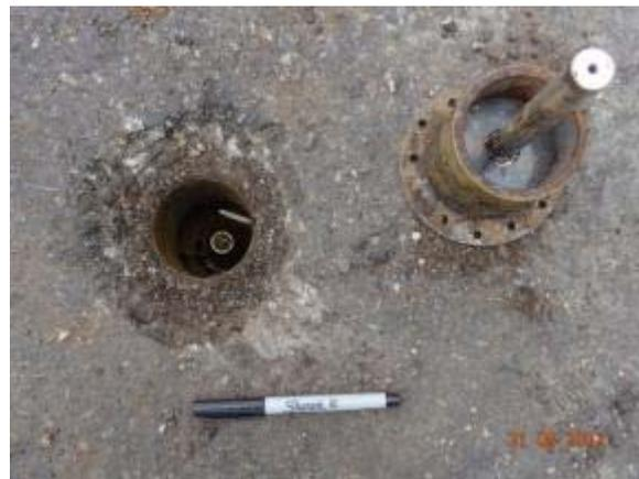
Figura 5.30. Deflectómetro 5 retirado de su perforación.
