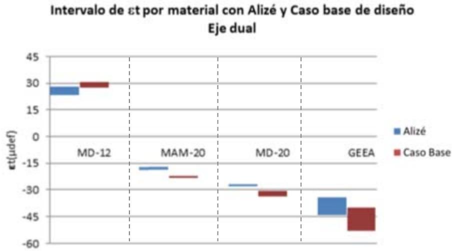
**Figura 10.32.** Intervalos de  $\mu_{def}$  perfiles de temperatura y caso base materiales asfálticos.
