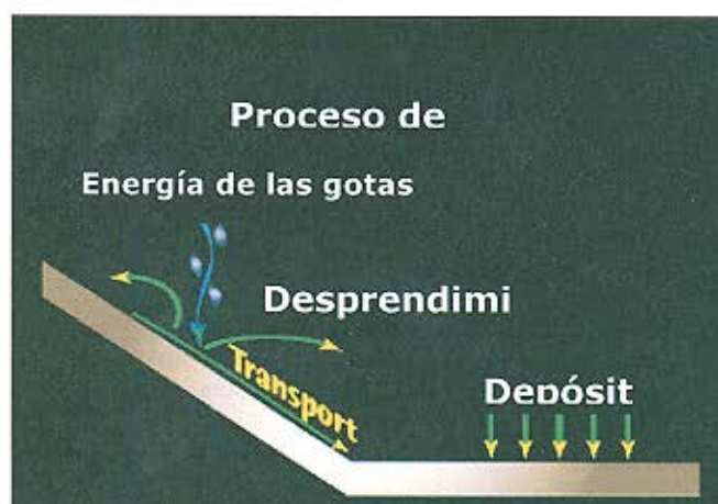
Figura 67. Proceso de Erosión por Agua Fuente: Cortesía Comité Técnico de Geosintéticos
