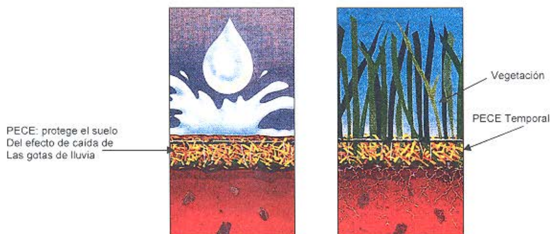
Figura 70. Instalación de PECE Fuente: Cortesía Comité Técnico de Geosintéticos
