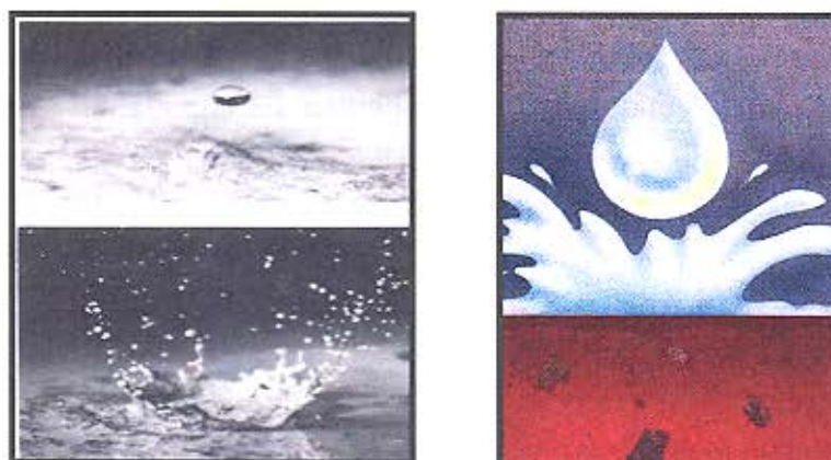
Figura 68. Desprendimiento de material por caída de gotas de lluvia Fuente: Cortesía Comité Técnico de Geosintéticos
