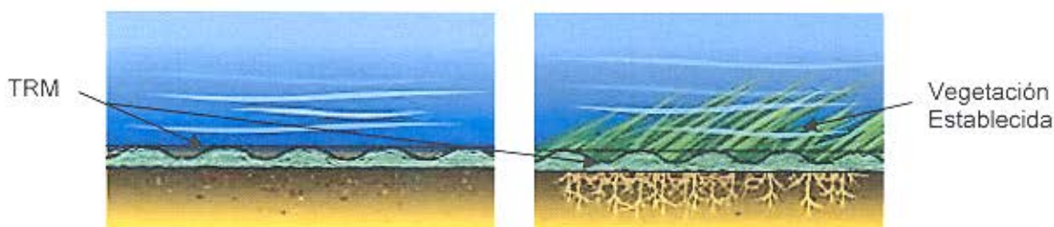
Figura 70. Colocación PECE permanente Fuente: Cortesía Comité Técnico de Geosintéticos
