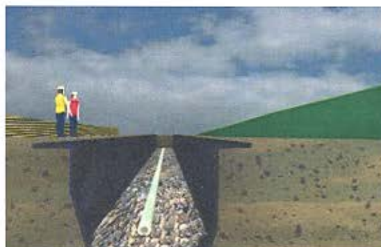
Figura 26 – Instalación de Tubería de Drenaje Fuente: Cortesía Comité Técnico de Geosintéticos
