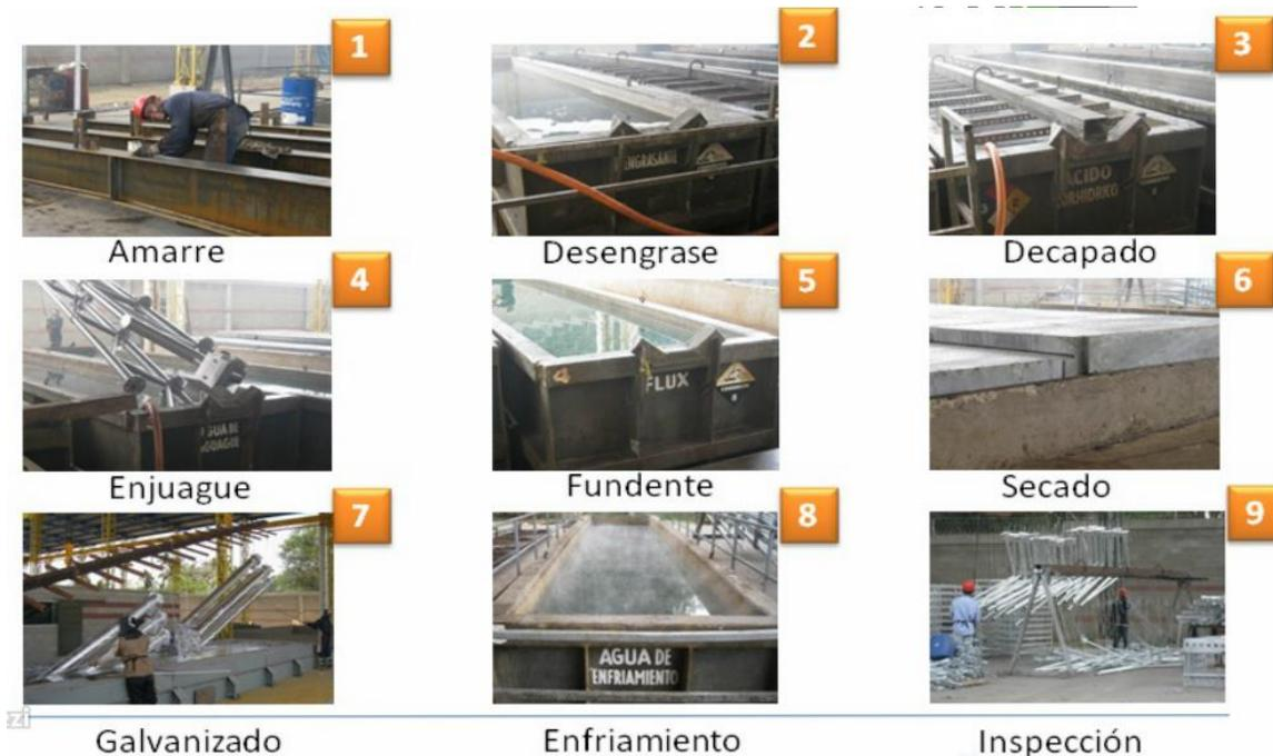
Figura 3. Proceso de galvanizado por inmersión en caliente.
