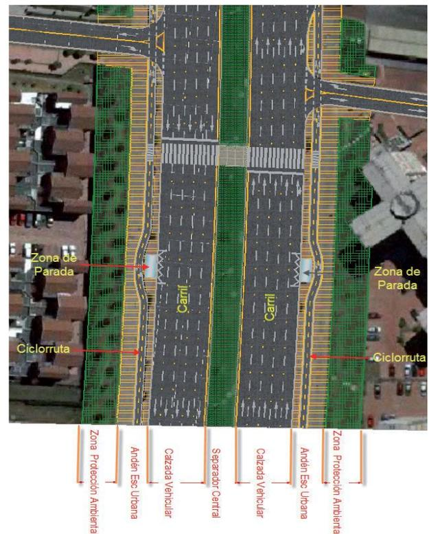
Figura 5. Ejemplo de elementos de las secciones transversales urbanas
