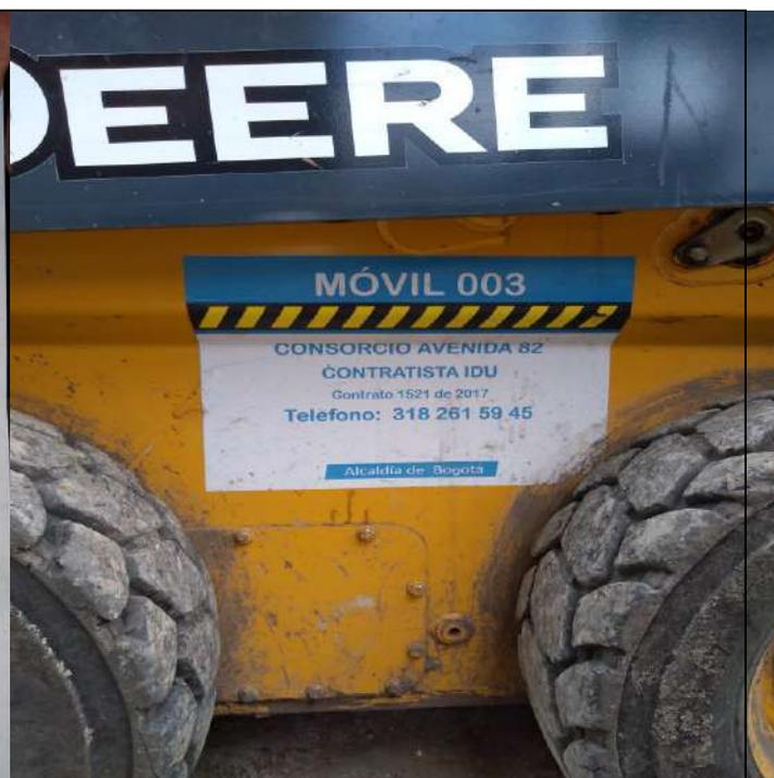
**Foto No. 13** Mini cargador sin alarma de reversa.
