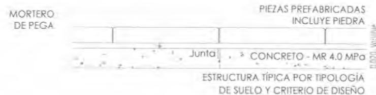
Losas enchapadas con losetas prefabricadas de concreto o piedra
