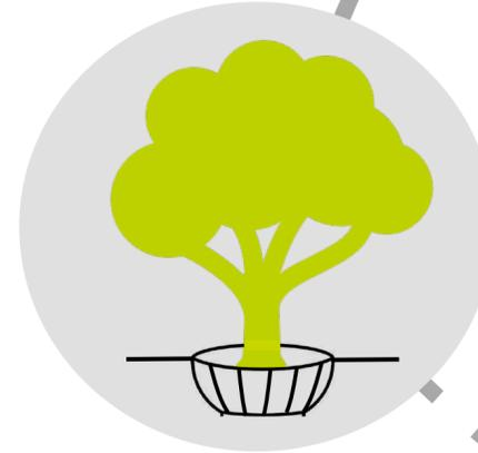
5. Realizar la excavación para conformar un bloque de tierra en forma de cono invertido (forma de V) alrededor de las raíces del árbol. La medida del diámetro de la excavación y su profundidad, dependen de la proporción del tronco, la altura y la cantidad de ramas que tenga el árbol.
