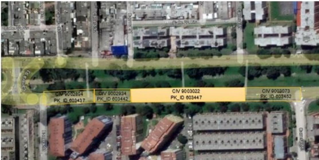
Las obras ejecutadas en el segmento de la Calle 22 entre Carrera 89 y 91 (calzada sur) corresponden a reacción por medio de técnicas de parcheo; las cuales se ejecutaron por fresado y reposición de la carpeta asfáltica en un espesor de 7.5 centímetros en mezcla asfáltica de tipo MD25. Estas actividades se ejecutaron en cumplimiento de la normatividad IDU y de los lineamientos establecidos en el Apéndice A del contrato de obra IDU 1712 de 2021.
