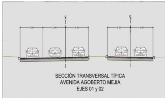
Ilustración 4. Sección transversal típica proyectada avenida Agoberto Mejía.
