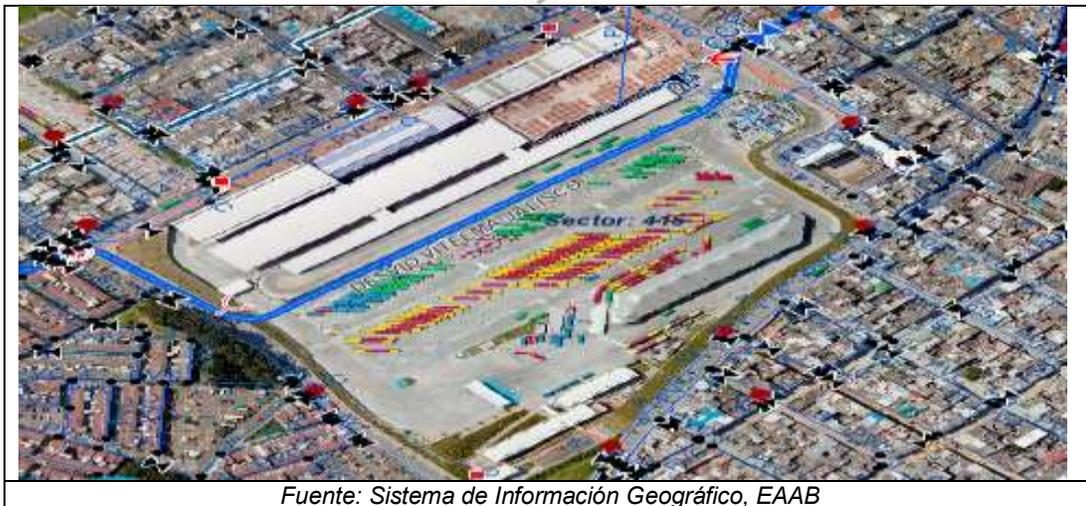
De la información recopilada, se resalta la existencia de la tubería de red matriz de 24” que cruza el Portal del 20 de Julio, línea matriz que no será afectada por la estación del Cable, no obstante para la siguientes fase del proeycto, se deberá investigar en sitio la localización de la tubería para evitar afectaciones por el proyecto.
