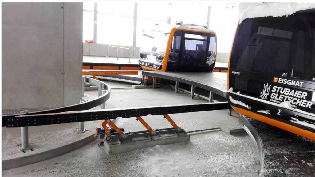
Figura 6. Zona de transferencia entre dos secciones. Fuente: Elaboración propia.
