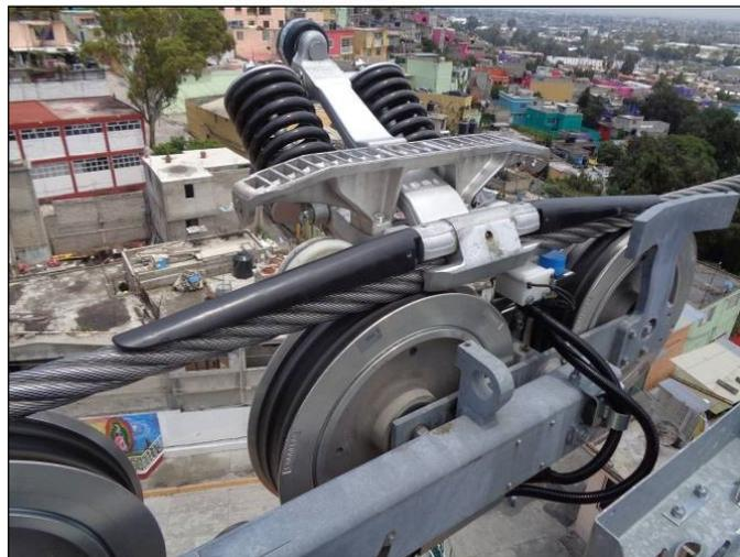
Figura 9. Ejemplo de pinza desembragable a su paso por una torre de línea. Fuente: elaboración propia.
