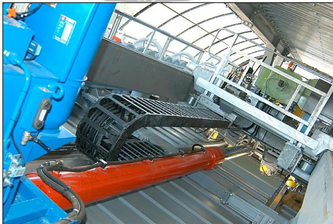
Figura 3. Pistón de tensión y carro móvil. Fuente: Elaboración propia.
