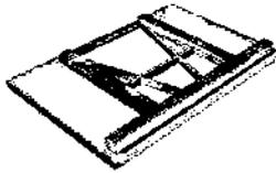
**Barras de anclaje (Junta Longitudinal)**
