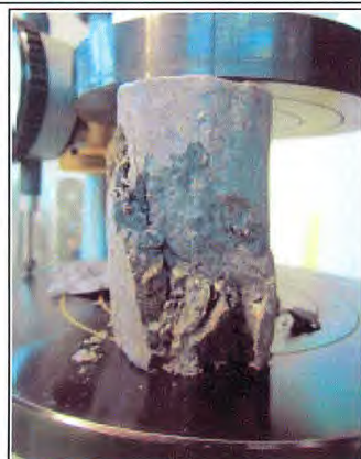
Fotografía de la falla
