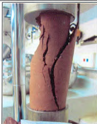
Fotografía de la falla
