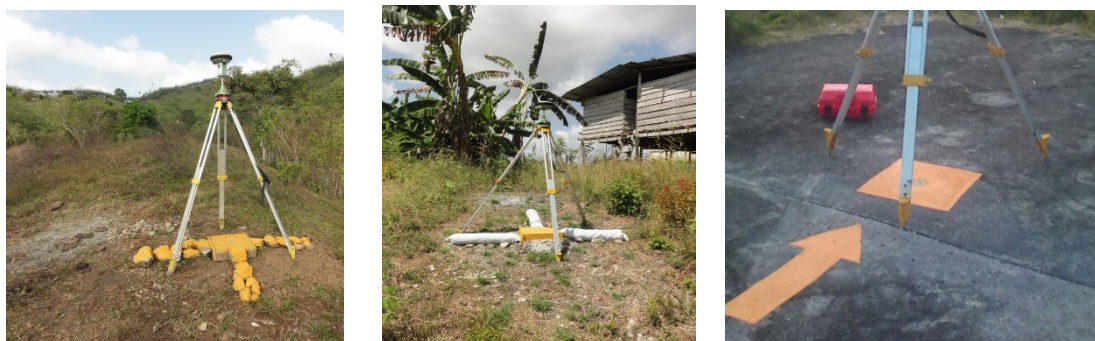
Figura 19. Ejemplo materialización e iluminación de puntos GCP's.
