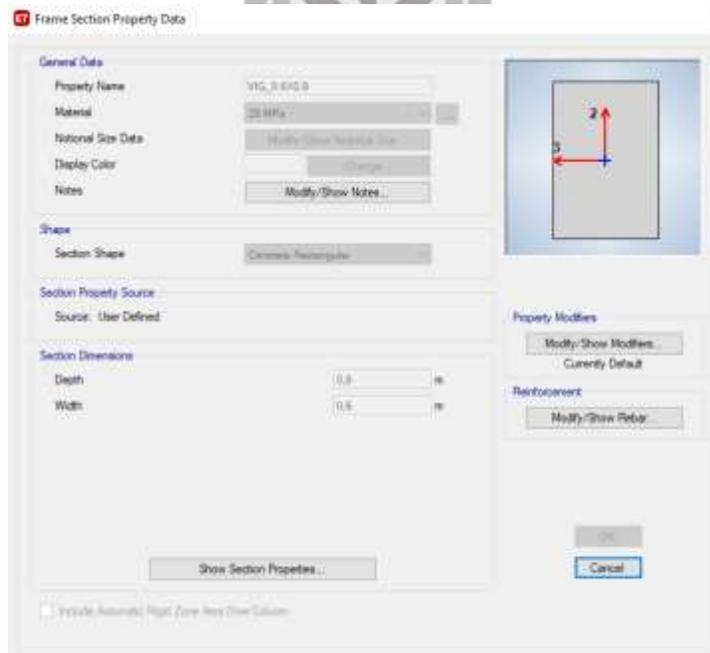
**Figura 16.85** – Definición de vigas típicas
