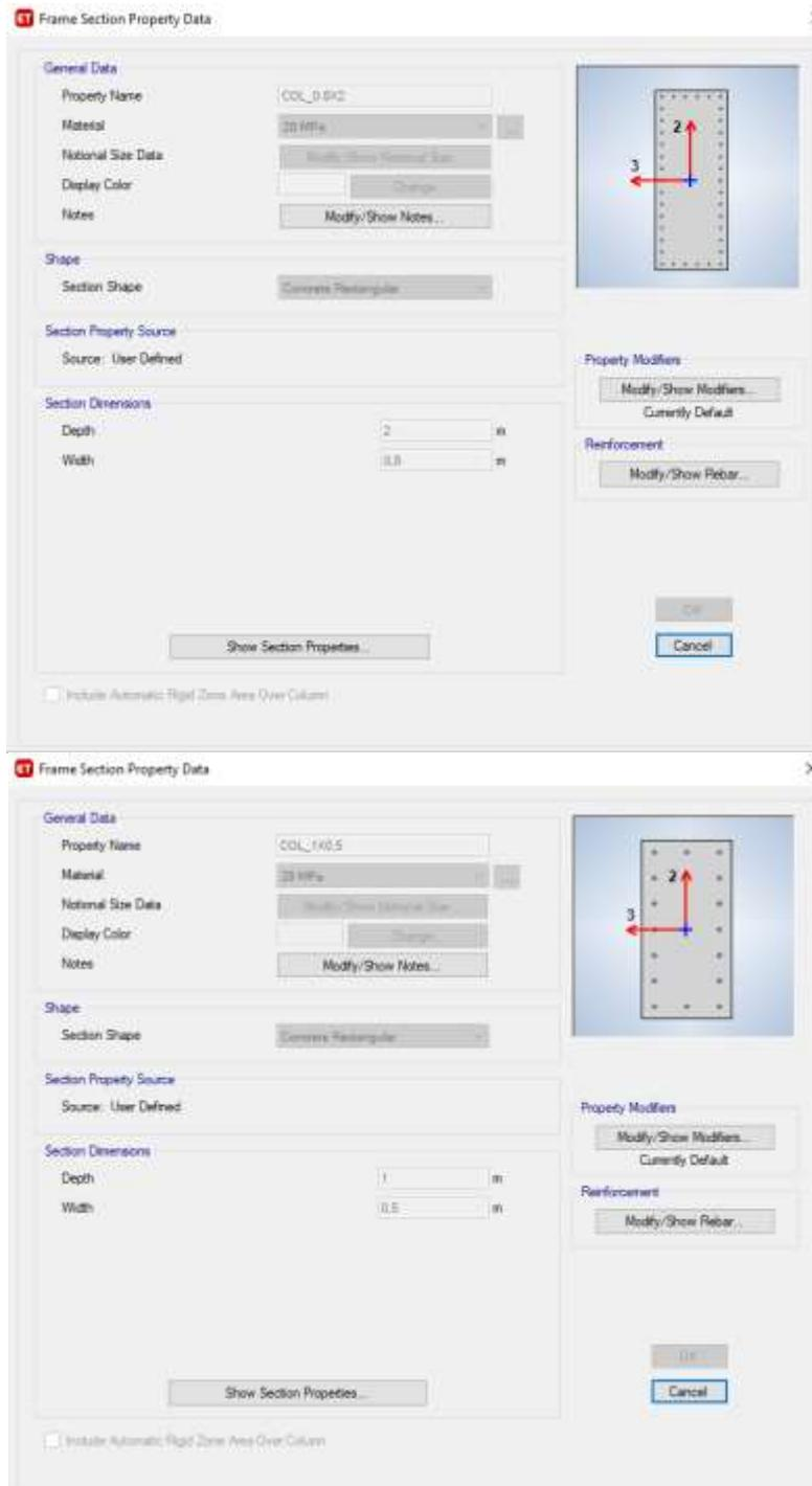
**Figura 16.84 – Definición columnas típicas**
