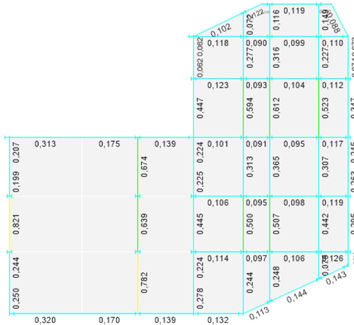
Figura 16.79 – Índices de sobrefuerzo en vigas
