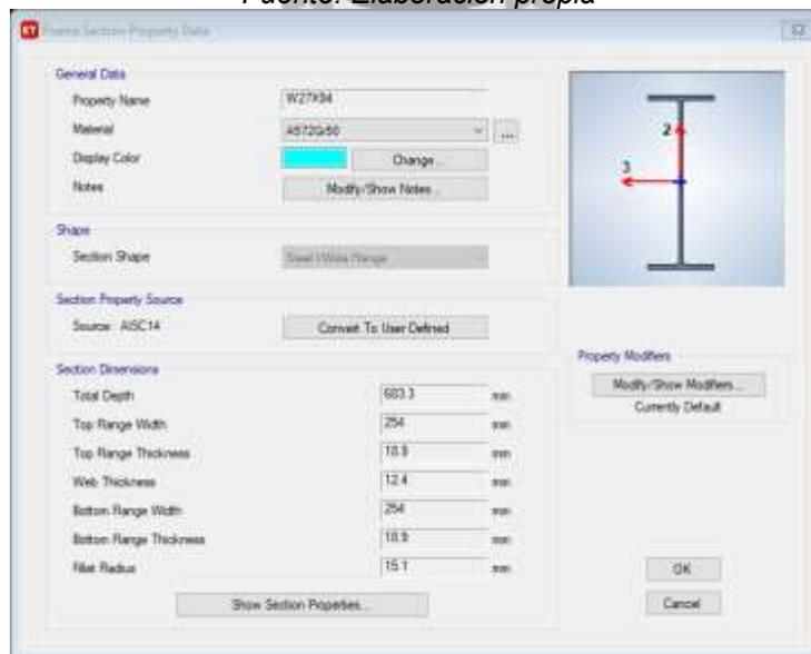
**Figura 16.38 – Definición de viga de PRM.**
