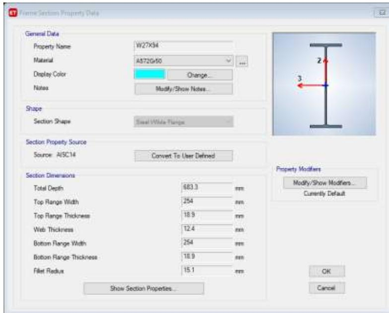
**Figura 16.10 – Definición de viga de PRM.**
