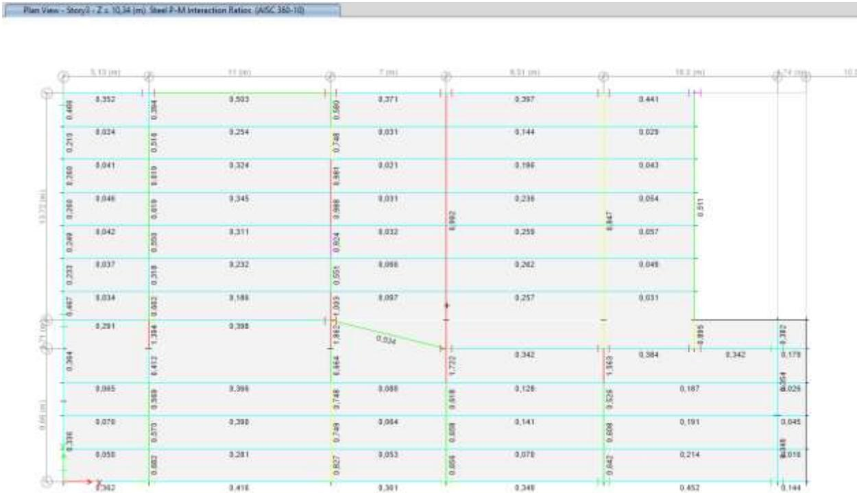
Figura 16.102 – Índices de sobrefuerzo en vigas
