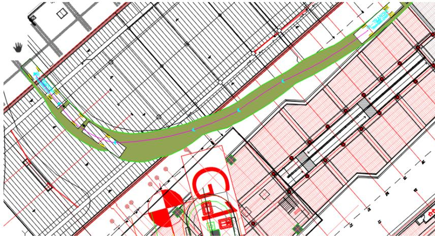
Figura 46 Simulación de trayectorias BRT
