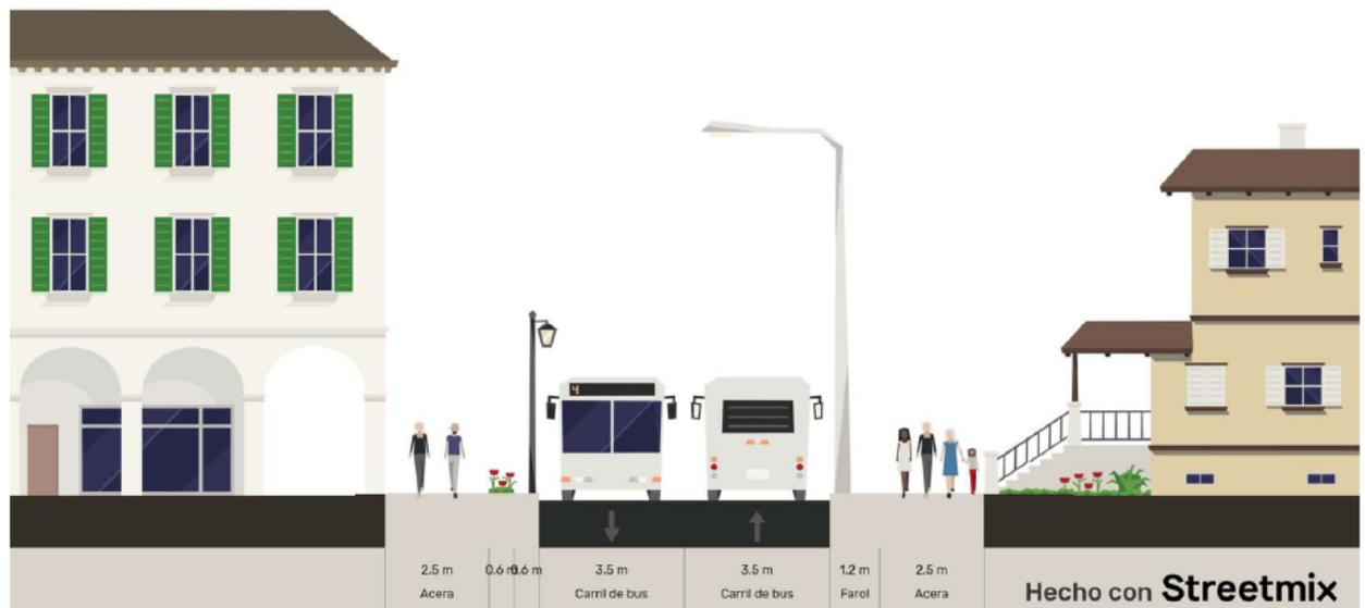
Figura 31 Sección Vial Bidireccional con transporte público
