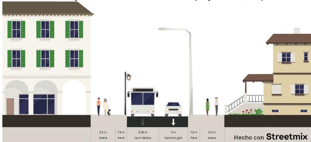
Figura 30 Sección Vial Unidireccional con transporte público
