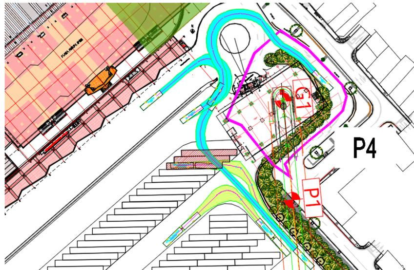
Figura 43 Simulación de trayectorias BRT (Verde) y Alimentadores (Cyan)
