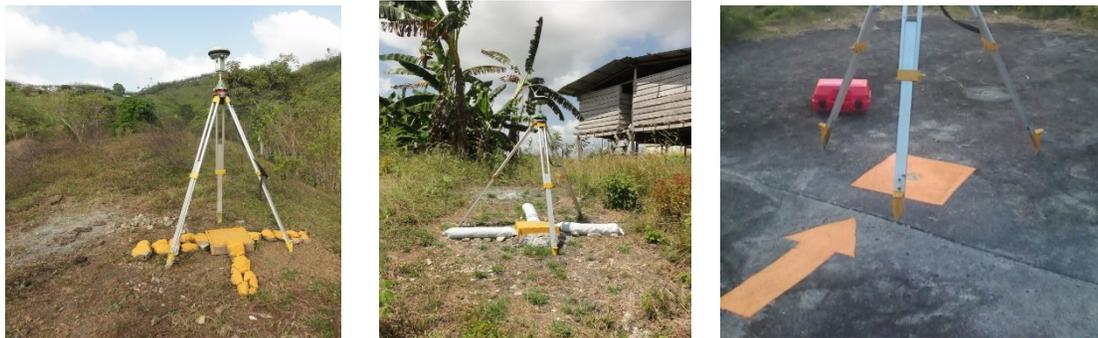
Figura 19. Ejemplo materialización e iluminación de puntos GCP's.
