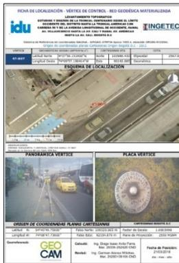
Figura 23. Ejemplo compendio de coordenadas y ficha de localización puntos GCP's.
