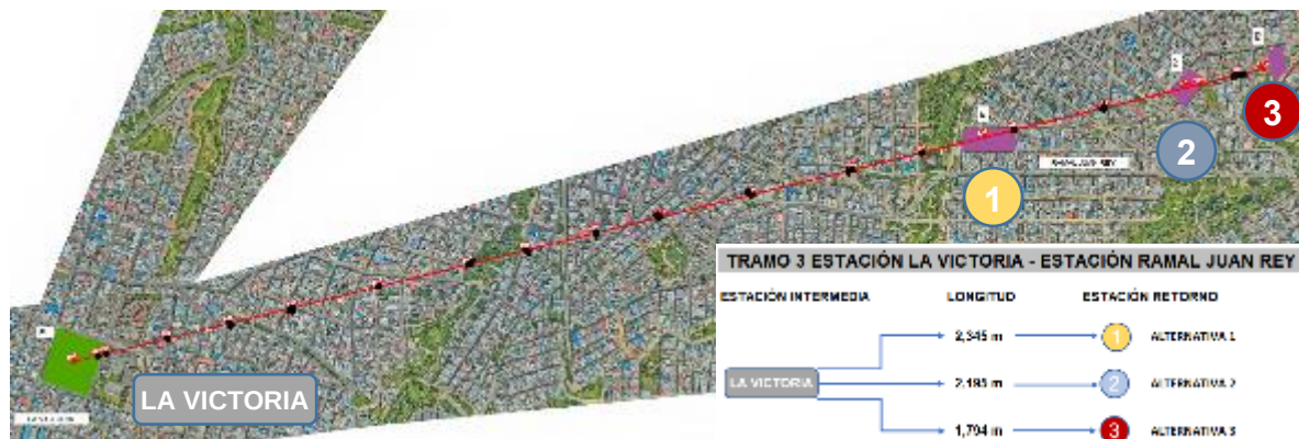
Figura 5-7. Tramo 3 Estación Retorno Ramal Juan Rey, Cable San Cristóbal
