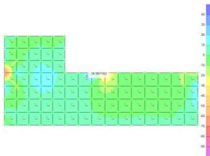
Figura 19.14 Momento M22 mínimo – Envolvente
