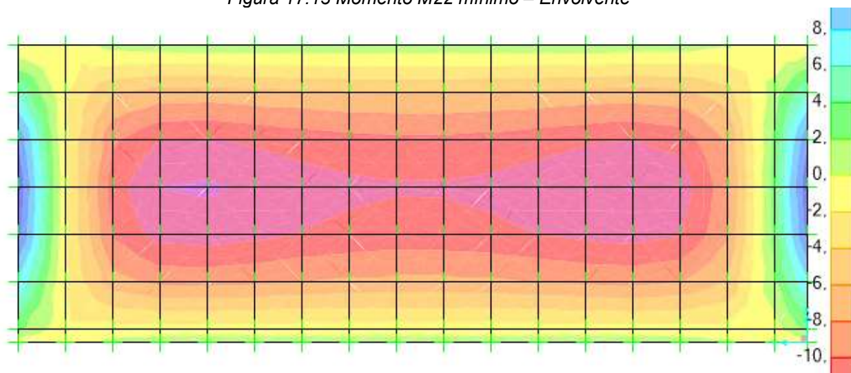
Figura 17.13 Momento M22 mínimo – Envolvente
