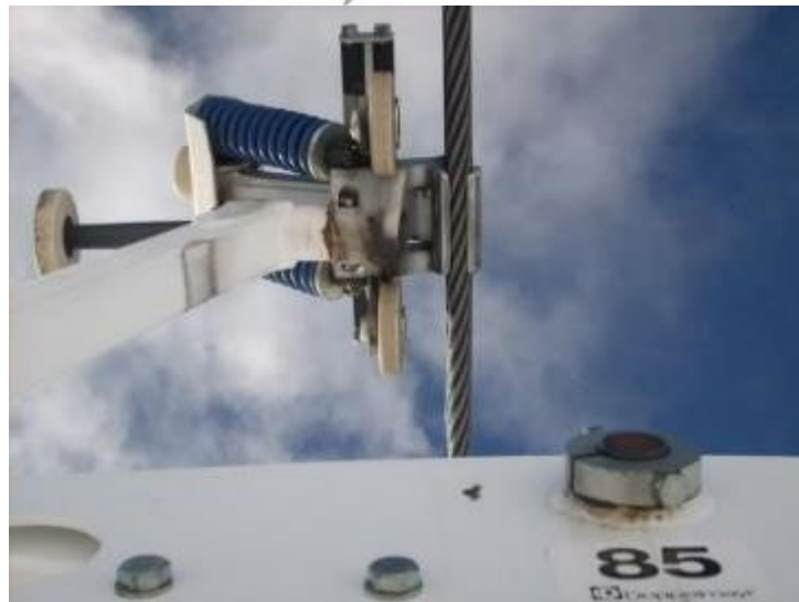
Figura 6-29. Ejemplo de pinza desembragable.
