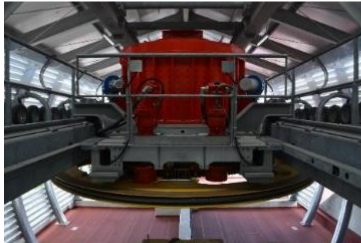
Figura 6-1. Cadena cinemática sobre la estructura de estación. Mexicable de Ecatepec.
