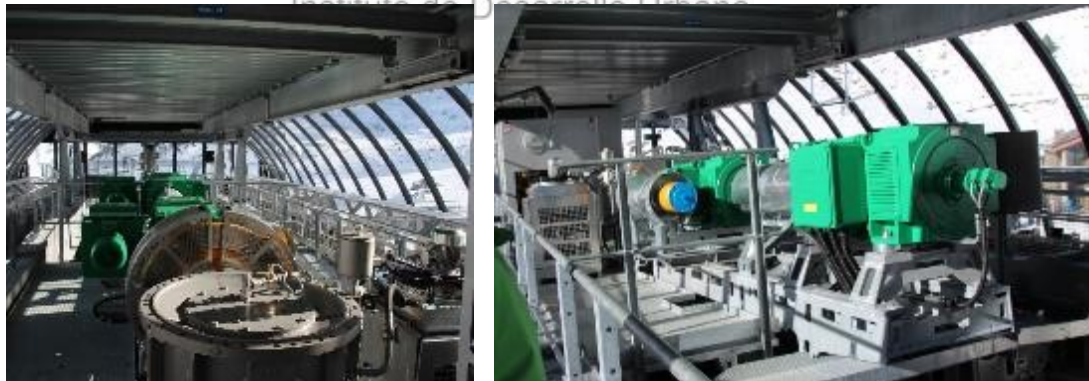
Figura 6-3. Cadena cinemática del Telecable de Tristaina. Andorra. Se observa en (gris) el reductor, en amarillo el volante de inercia y en verde los motores en funcionamiento maestro/esclavo.
