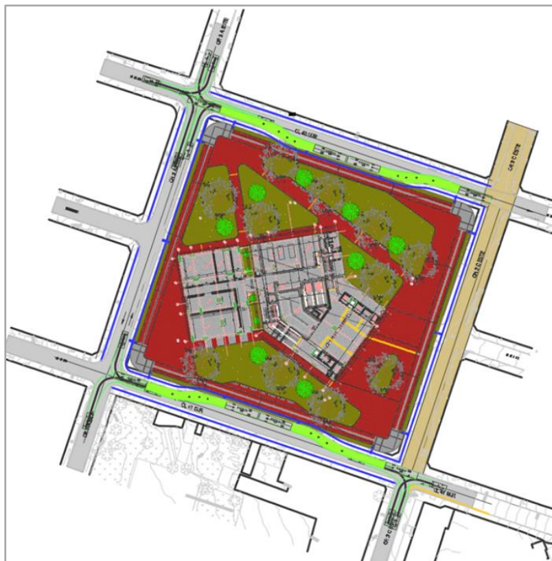
Figura 3-4 Geometría vial proyectada. Estación La Victoria.
