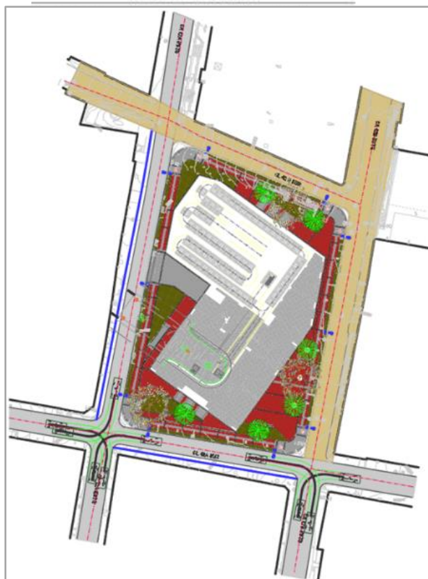
Figura 3-7 Geometría vial proyectada. Estación Altamira.
