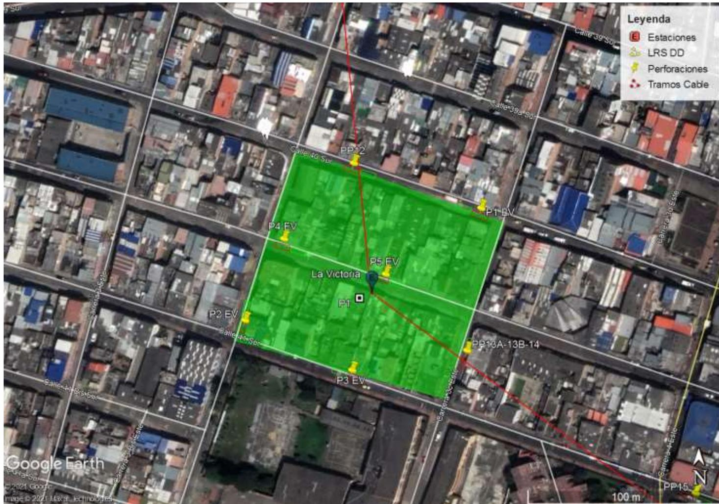
Figura 5-5. Exploración geotécnica estación La Victoria
