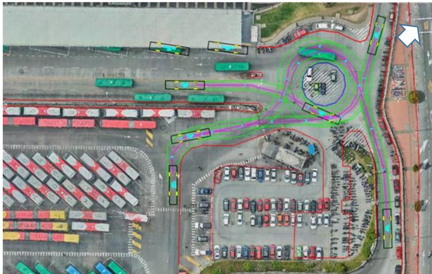
*Figura 47 Simulación trayectorias Accesos y Salidas del Patio*
