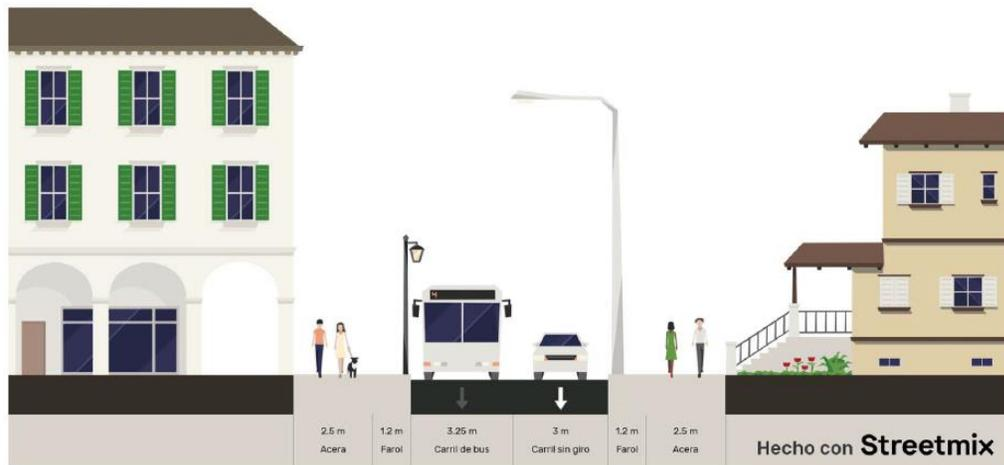
Figura 31 Sección Vial Unidireccional con transporte público
