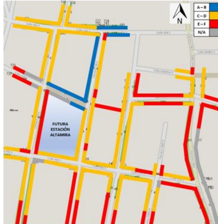
Figura 152. NDS andenes Estación Altamira - Año 2021
