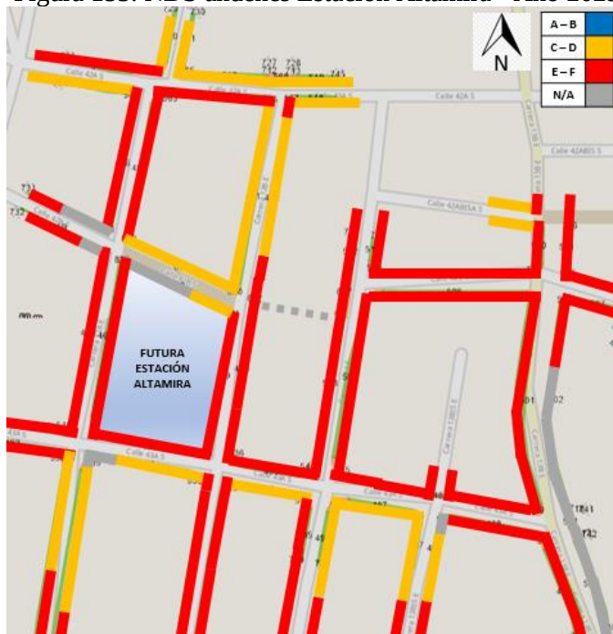
Figura 153. NDS andenes Estación Altamira - Año 2025
