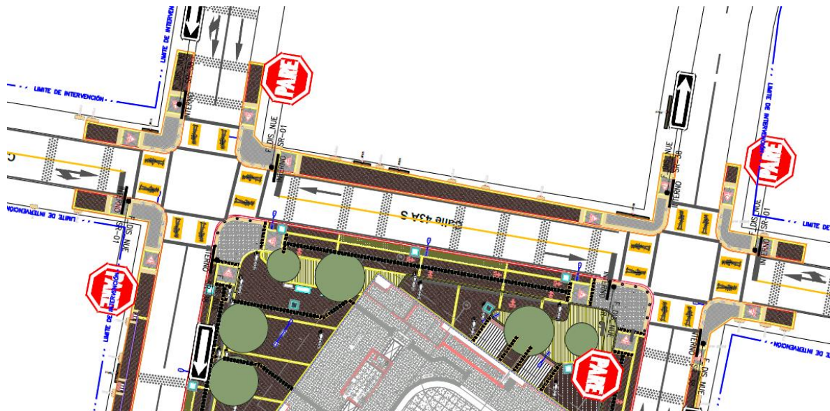
Figura 175. Señalización intersecciones alrededor de la estación sobre la Calle 43a Sur
