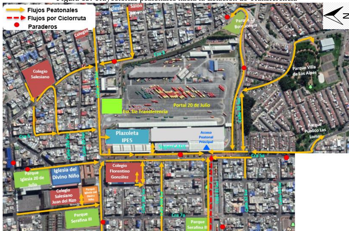
Figura 19. Trayectorias peatonales hacia la Estación de Transferencia
