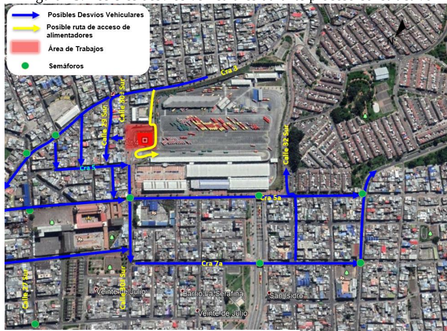
Figura 25. Posibles desvíos vehiculares durante proceso constructivo
