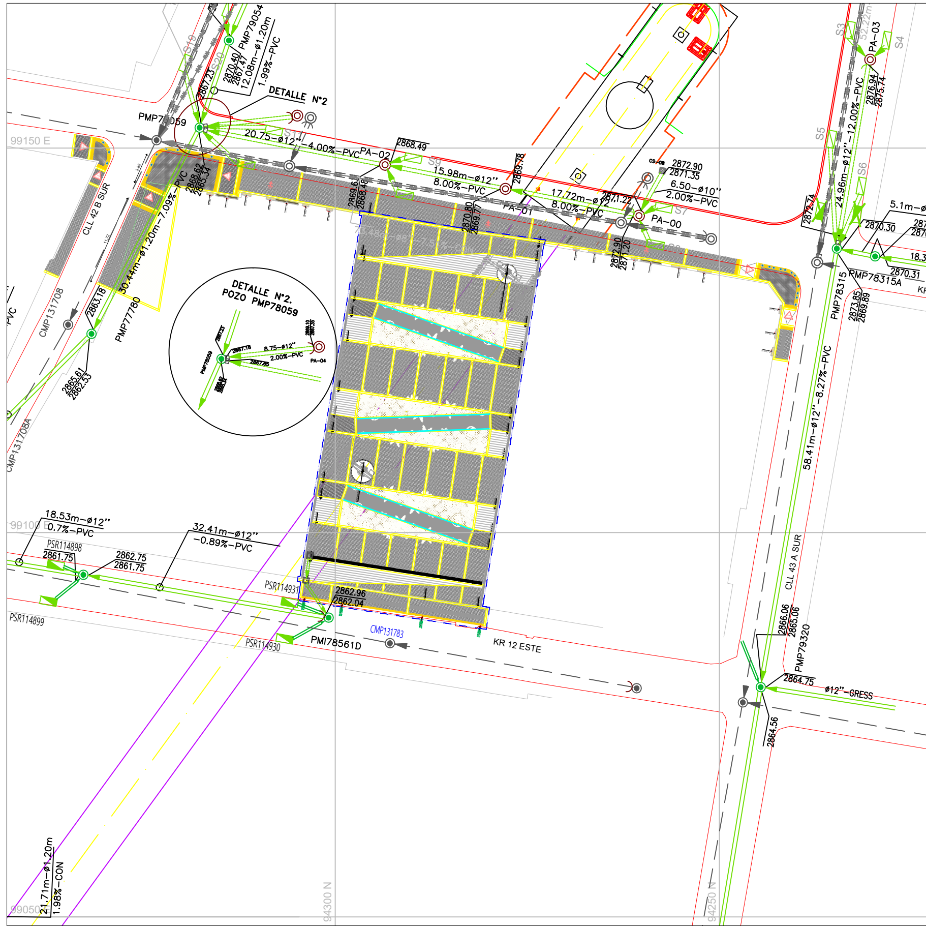
PLANTA DRENAJE SUPERFICIAL PILONA 21-22 ESCALA: 1: 500
