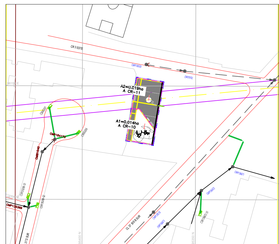
PLANTA AREAS DE DRENAJE PILONA 9 ESCALA: 1: 1000
