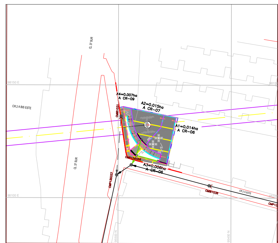
PLANTA AREAS DE DRENAJE PILONA 8 ESCALA: 1: 1000
