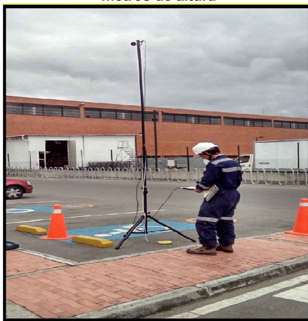
Ilustración 1. Montaje del sonómetro para el monitoreo de ruido ambiental micrófono a 4 metros de altura
