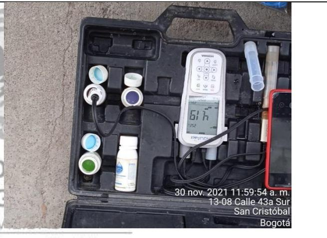
Calibración equipos para toma muestras In-situ (aguas arriba Quebrada Chorro Colorado)
