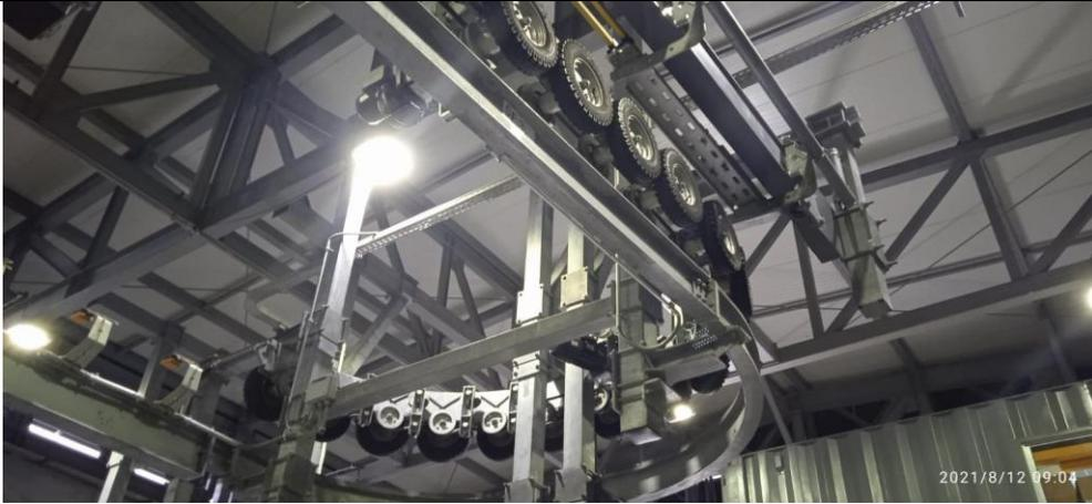
Parking de Cabinas. Riel para transporte de cabinas a Parking
