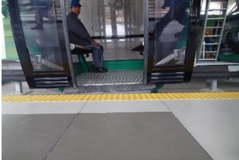
Ilustración 1-10 Nivel del piso de la cabina coincide con el nivel del andén (sin escalón). Línea Verde de Mi Teleférico. La Paz, Bolivia
