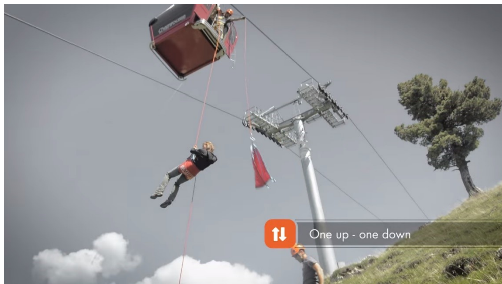
Figura 3-5. Descenso en vertical (en zonas donde no hay obstáculos)
