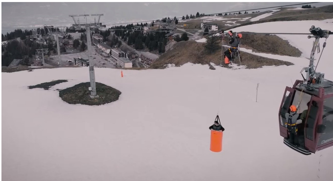
Figura 3-9. Rescate mediante cesta con traslado por cable.
