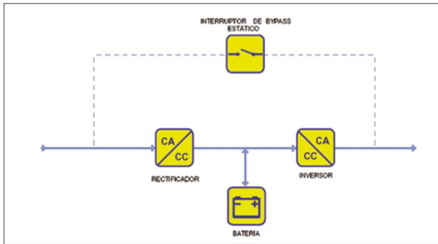
**Figura - 2 – Conexión UPS**
