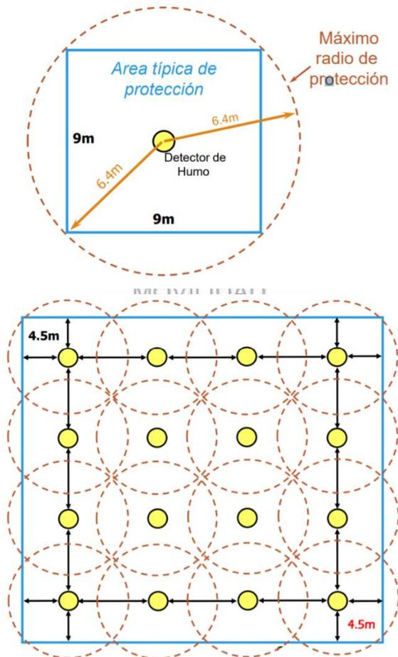
Figura - 5 – Área típica de protección
