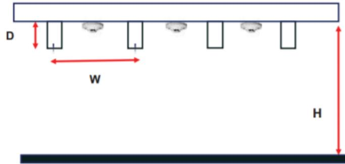
Figura - 3 – Ubicación de sensores en áreas con casetón a la vista
