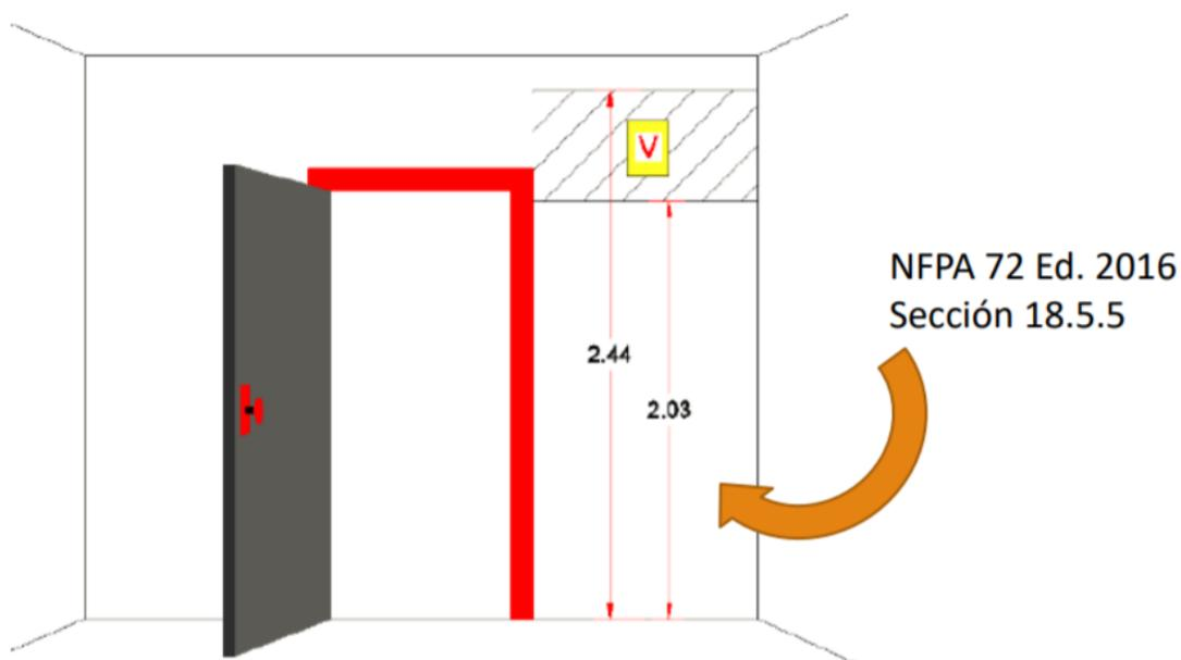
Figura - 7 – Localización sirenas de luz estroboscópicas
