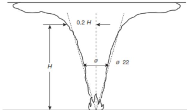
Figura - 4 – Divergencia de columna de humo de un incendio
