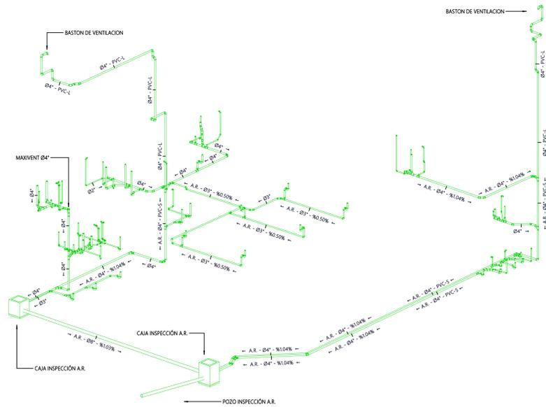
01 DETALLE - ISOMETRICO RED A.R. - SECCIÓN A-D
